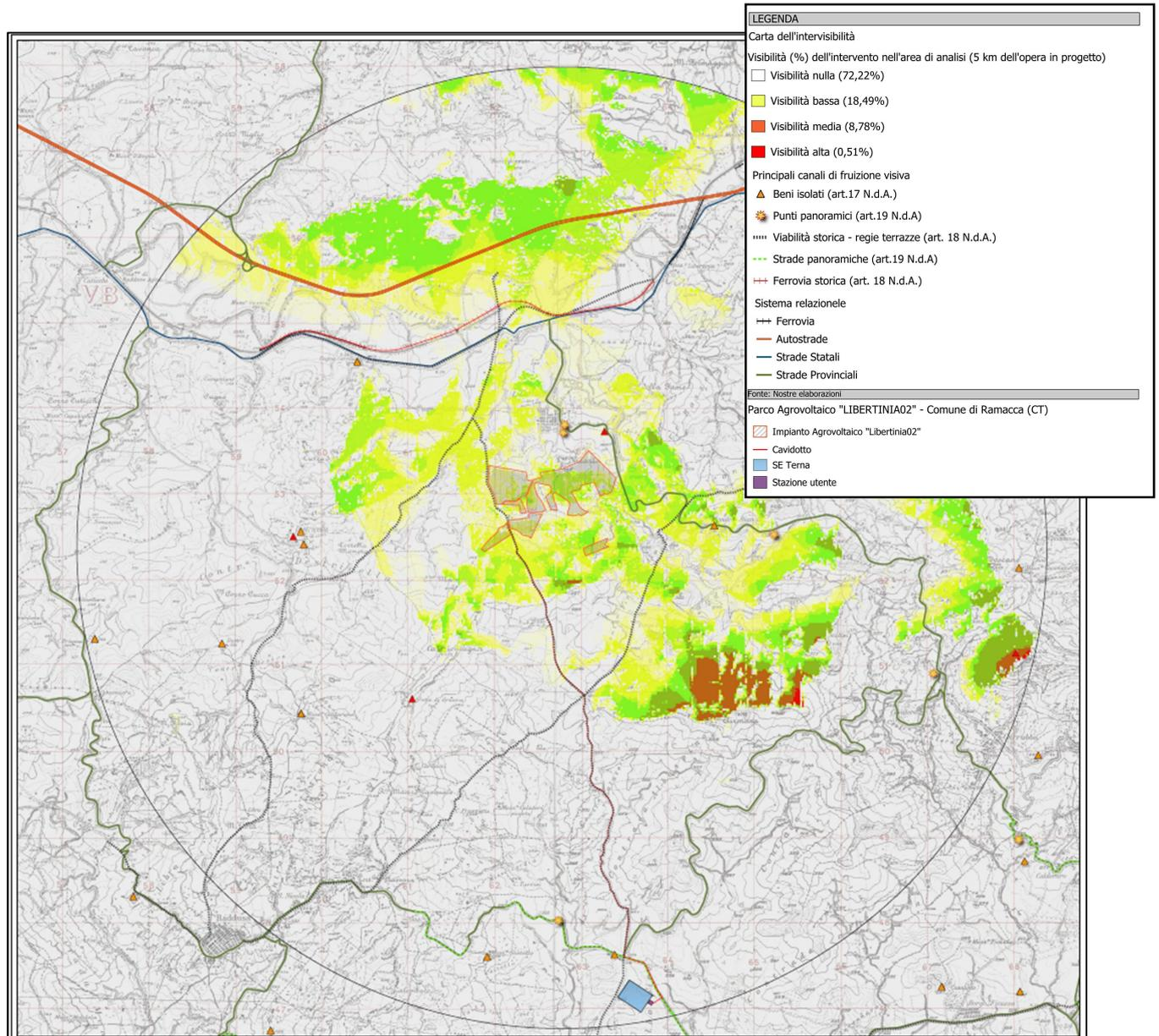
Figura 9-1 – Risultato analisi di intervisibilità dell'opera in progetto
