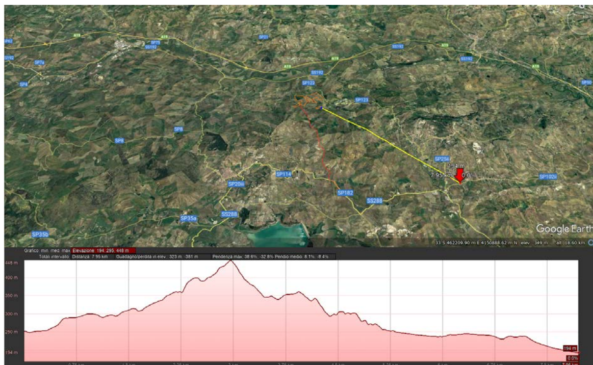
Figura 25: illustrazione della distanza tra il punto di osservazione individuato sulla SP 102ii e l'impianto della ITS TURPINO SRL; come visibile dall'andamento della pendenza del terreno vi sono ostacoli naturali che ne impediscono la visuale - Fonte: Google Earth
