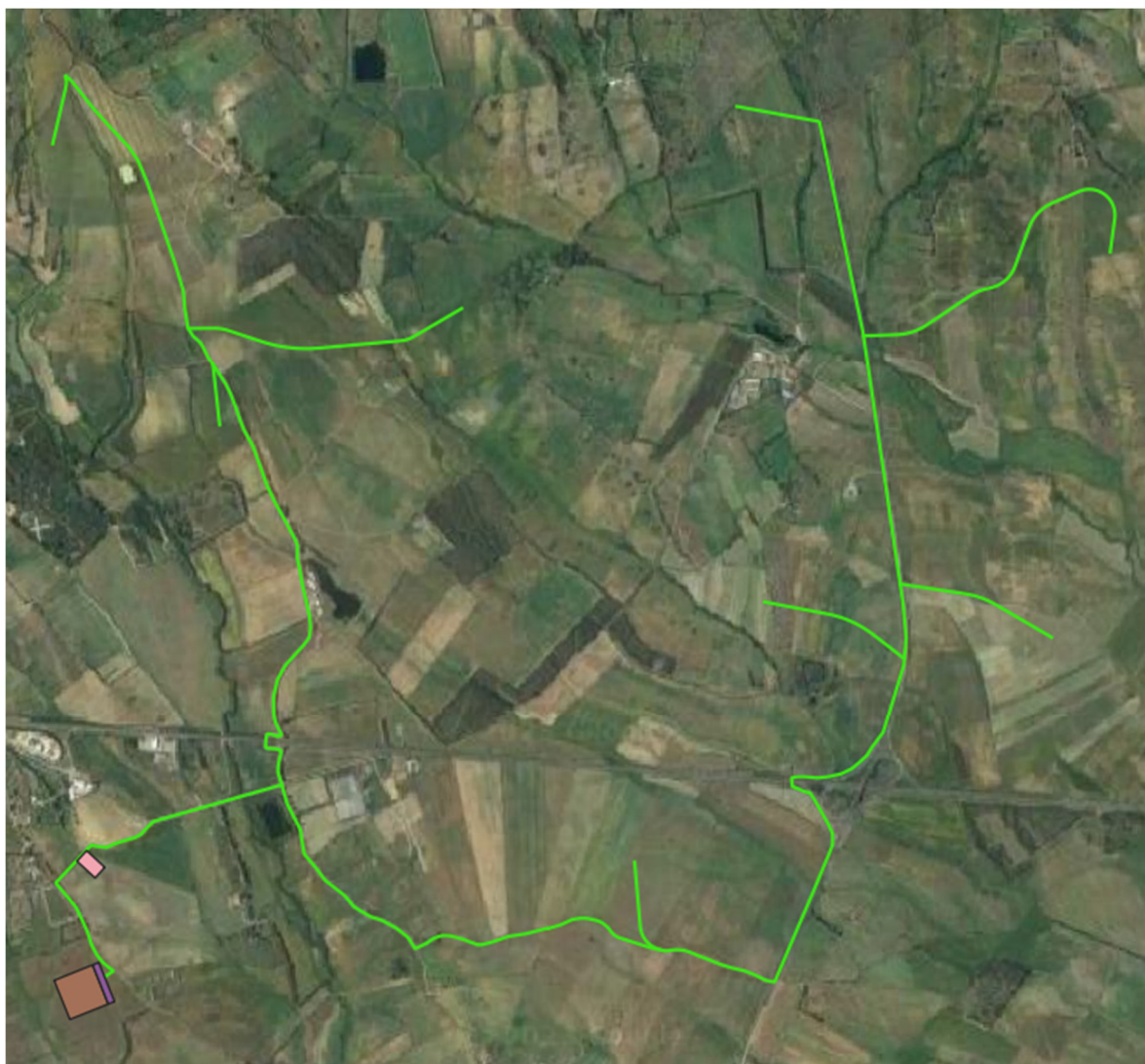
Figura 3.9: Cavidotto MT/AT (in verde) di collegamento con la SE TERNA di nuova realizzazione (in marrone) e il suo ampliamento (in viola). In rosa l'area cabine di raccolta e smistamento.
