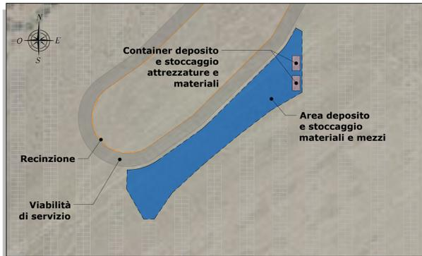
DETTAGLIO 7 - AREA DI CANTIERE - SCALA 1:500
