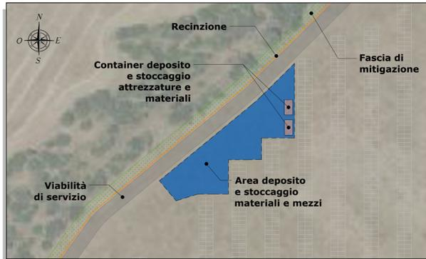
DETTAGLIO 6 - AREA DI CANTIERE - SCALA 1:500
