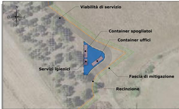
DETTAGLIO 8 - AREA DI CANTIERE - SCALA 1:500
