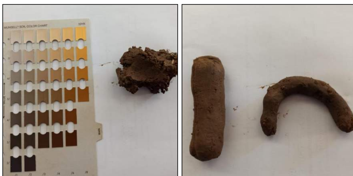
Figura 3.55 - Analisi colori con Munsell Soil Color Chart Figura 3.56 - Prova dei cilindretti per stima tessitura
