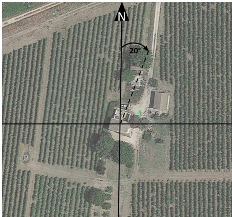
Figura 3-6 Esempio di identificazione dell'orientamento delle finestre dei ricettori
