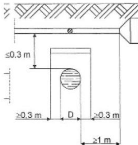
Figura 28 - disegno esemplificativo di protezione delle tubazioni
