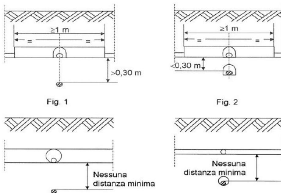
Figura 25 - disegno esemplificativo di Incrocio e parallelismo tra cavi AT e bt con cavi di telecomunicazioni interrati
