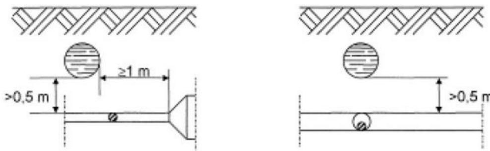
Figura 26 - disegno esemplificativo di Incrocio tra cavi AT e bt e tubazioni metalliche interrato
