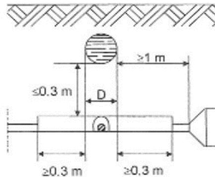
Figura 27 - disegno esemplificativo di Parallelismo tra cavi AT e bt e tubazioni metalliche interrate
