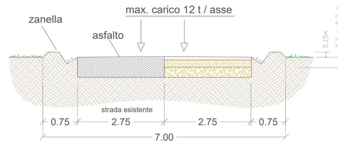
Sezione stradale tipo in scavo
