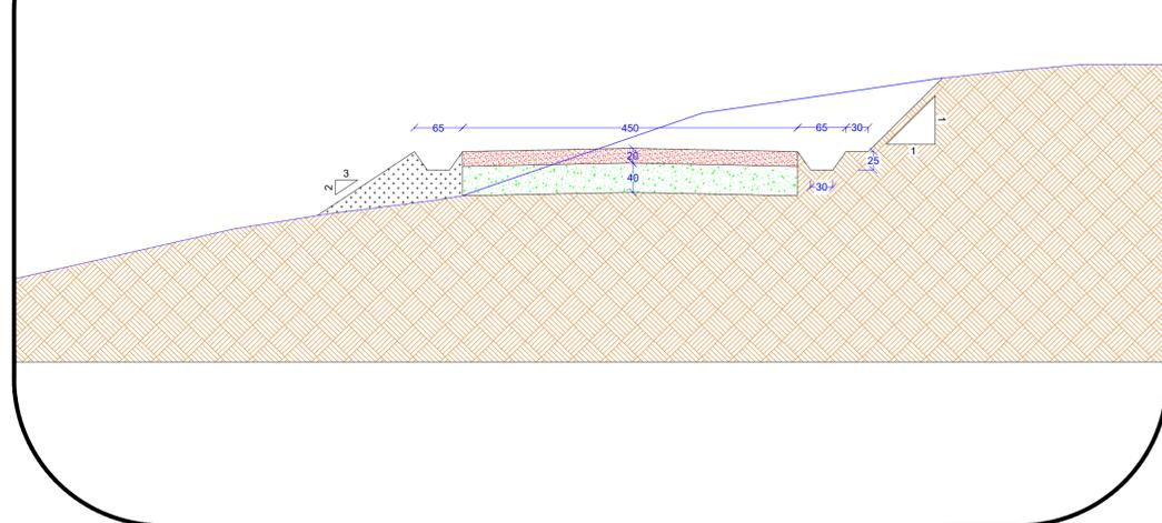
SEZIONE TIPO - STRADA IN RILEVATO
