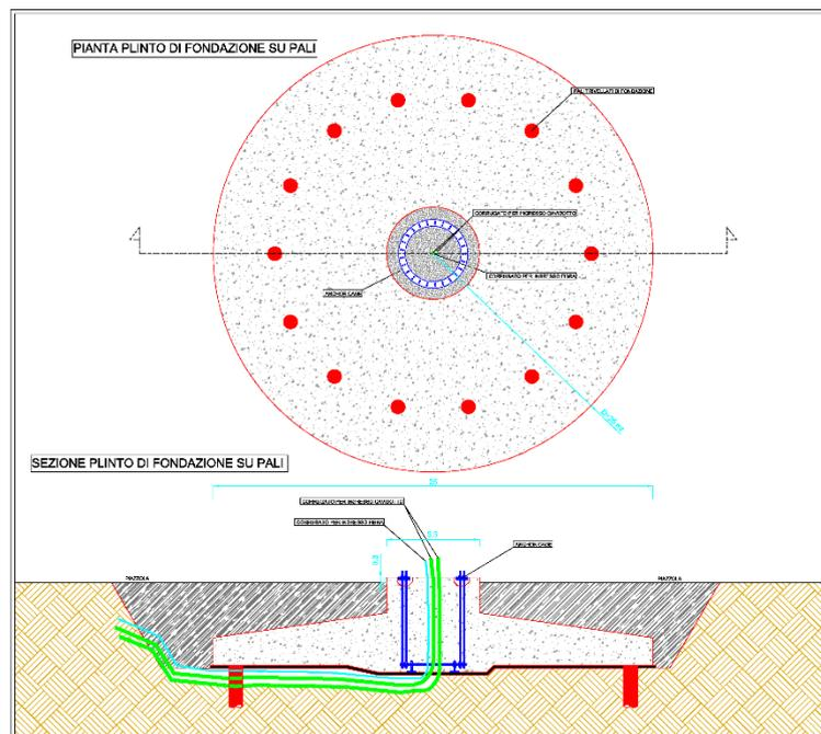
Le fondazioni saranno completamente interrato, così come le linee elettriche della rete interna al parco, pertanto non risulteranno visibili. Le verifiche di stabilità del terreno e delle strutture di fondazione saranno eseguite con i metodi e i procedimenti della geotecnica, tenendo conto delle massime sollecitazioni che la struttura trasmette al terreno. Le massime sollecitazioni sul terreno saranno calcolate con riferimento alla normativa vigente (DM 17/01/2018).
