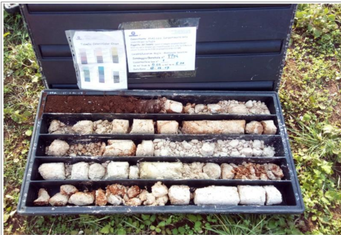
Limo sabbioso rossastro superficiale e calcarenite cementata leggermente vacuolare (PP4)
