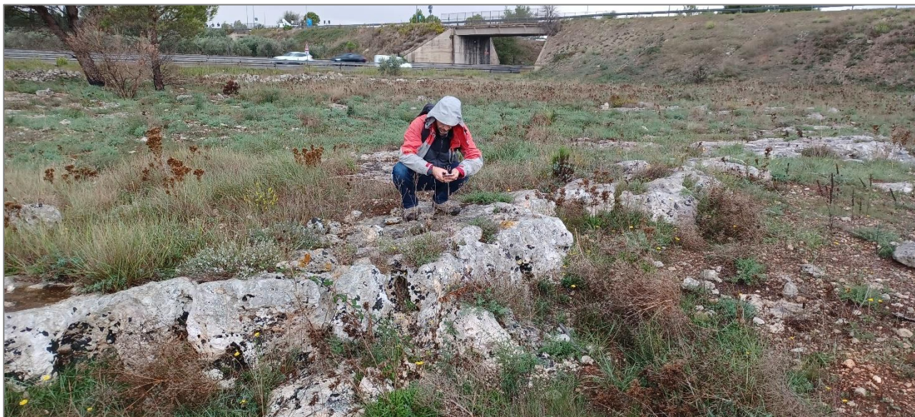
Figura 12-3 – Settore CV1 – Substrato calcarenitico affiorante (spalla ENE)
