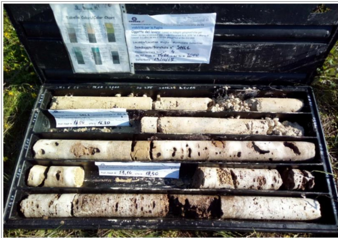
Calcarenite con vacuoli e cavità da centimetriche a decimetriche (SML1)
