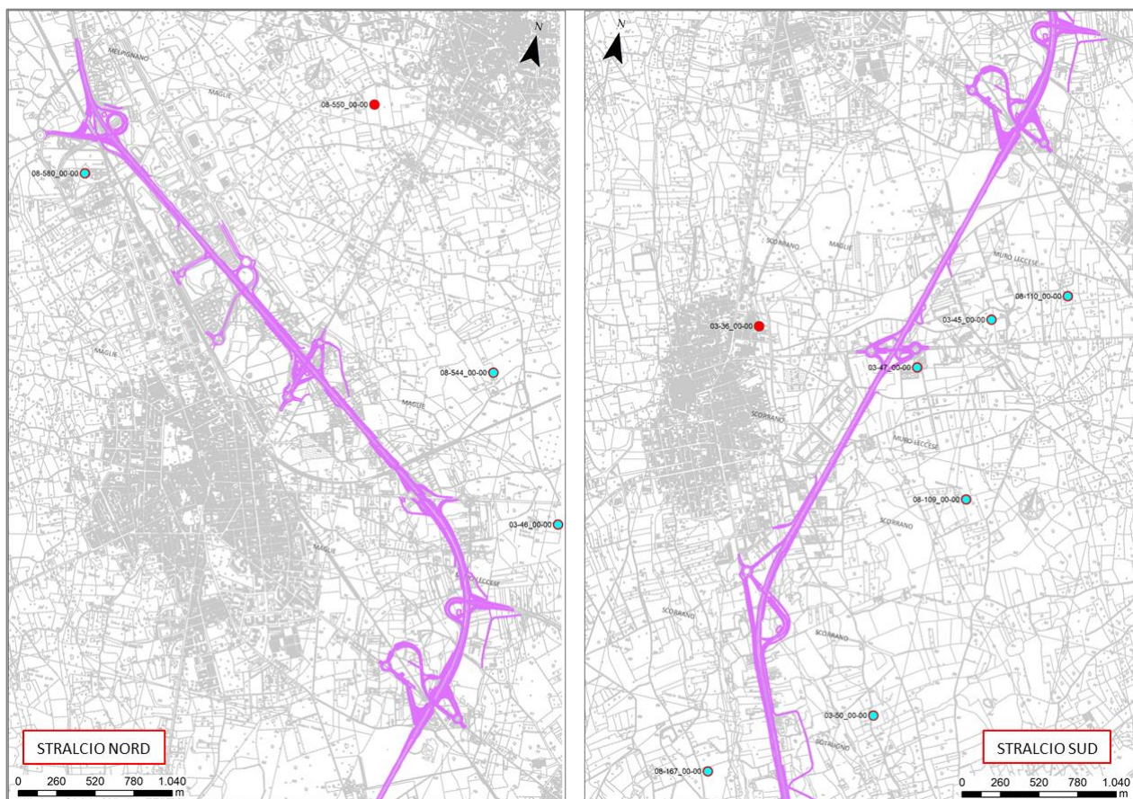
Figura 9-16: Distribuzione dei pozzi per acqua perforati nell'area dello Stralcio I (estratto da Piano Tutela delle Acque della Regione Puglia, aggiornato a giugno 2009).
