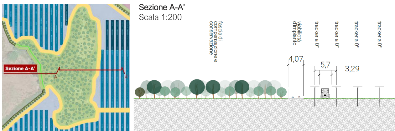
FIGURA 57 – PARTICOLARE AREA DESTINATA A CONSERVAZIONE E RELATIVA SEZIONE O-E DELL'IMPIANTO (ESTRATTO DALL'ELABORATO GRAFICO MACOMER4-PDT11)
