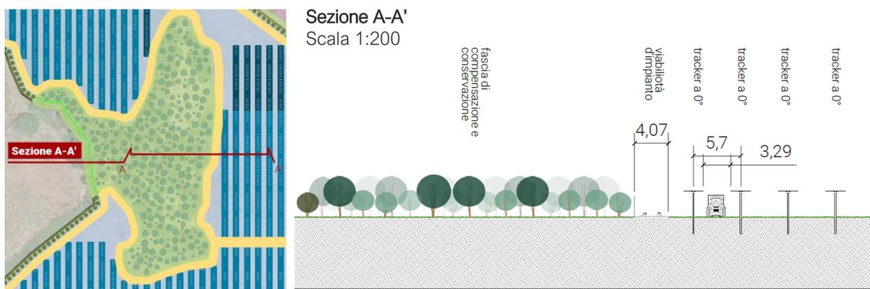
FIGURA 34 – PARTICOLARE AREA DESTINATA A CONSERVAZIONE E RELATIVA SEZIONE O-E DELL'IMPIANTO (ESTRATTO DALL'ELABORATO GRAFICO MACOMER4-PDT11)
