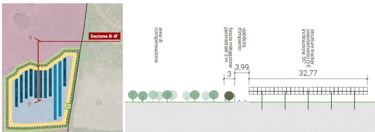
FIGURA 35 – PARTICOLARE FASCIA DI MITIGAZIONE E AREA DESTINATA A RINATURALIZZAZIONE E RELATIVA SEZIONE N-S DELL'IMPIANTO – ESTRATTO DALL'ELABORATO GRAFICO MACOMER4-PDT11)
