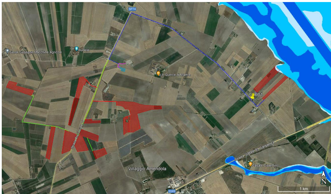
Figura 5.2: Stralcio piano assetto Idrologico (PAI) del bacino Candelaro. Parte del layout di impianto (sotto-aree C9 e C10) rientra nella fascia di pericolosità idraulica media e bassa.
