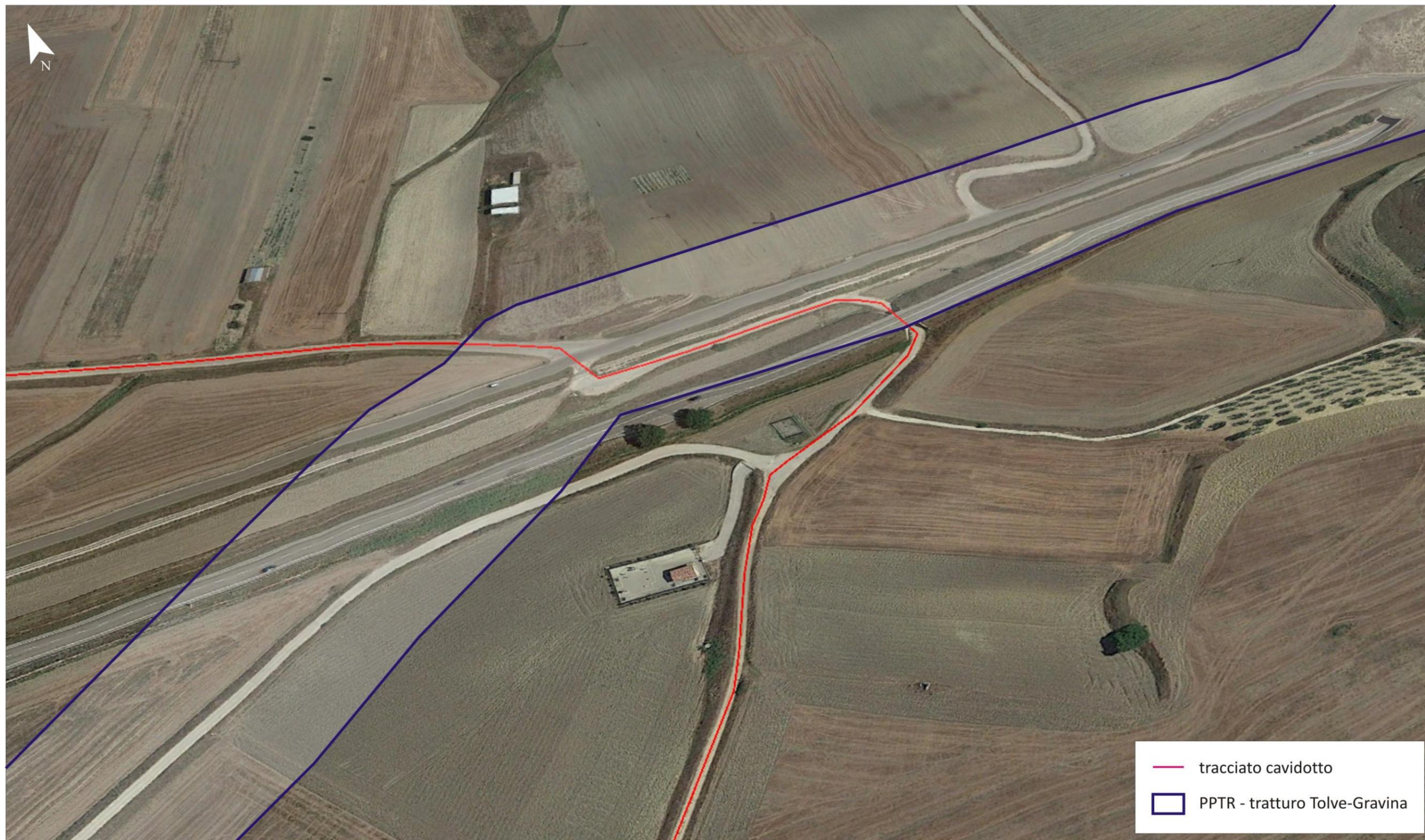
Figura 4 - SETTORE C, area di interferenza tra il tracciato del cavidotto ed il tratturo Tolve-Gravina individuato dal PPTR della Regione Puglia: layout dell'intervento sovrapposto al modello tridimensionale del terreno estratto da Google Earth.
