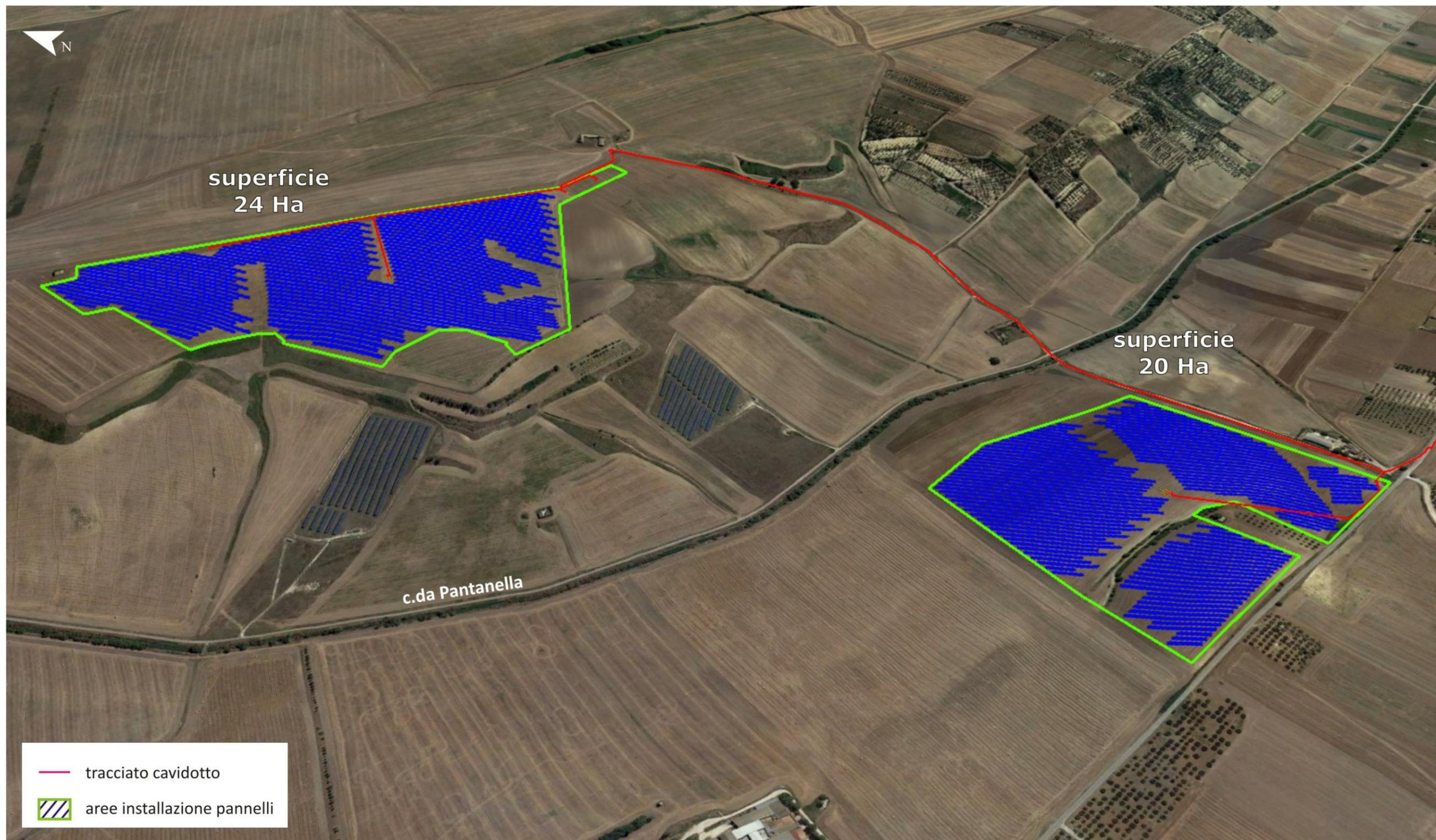
Figura 2 - SETTORE A, aree di installazione dei pannelli: layout dell'intervento sovrapposto al modello tridimensionale del terreno estratto da Google Earth.
