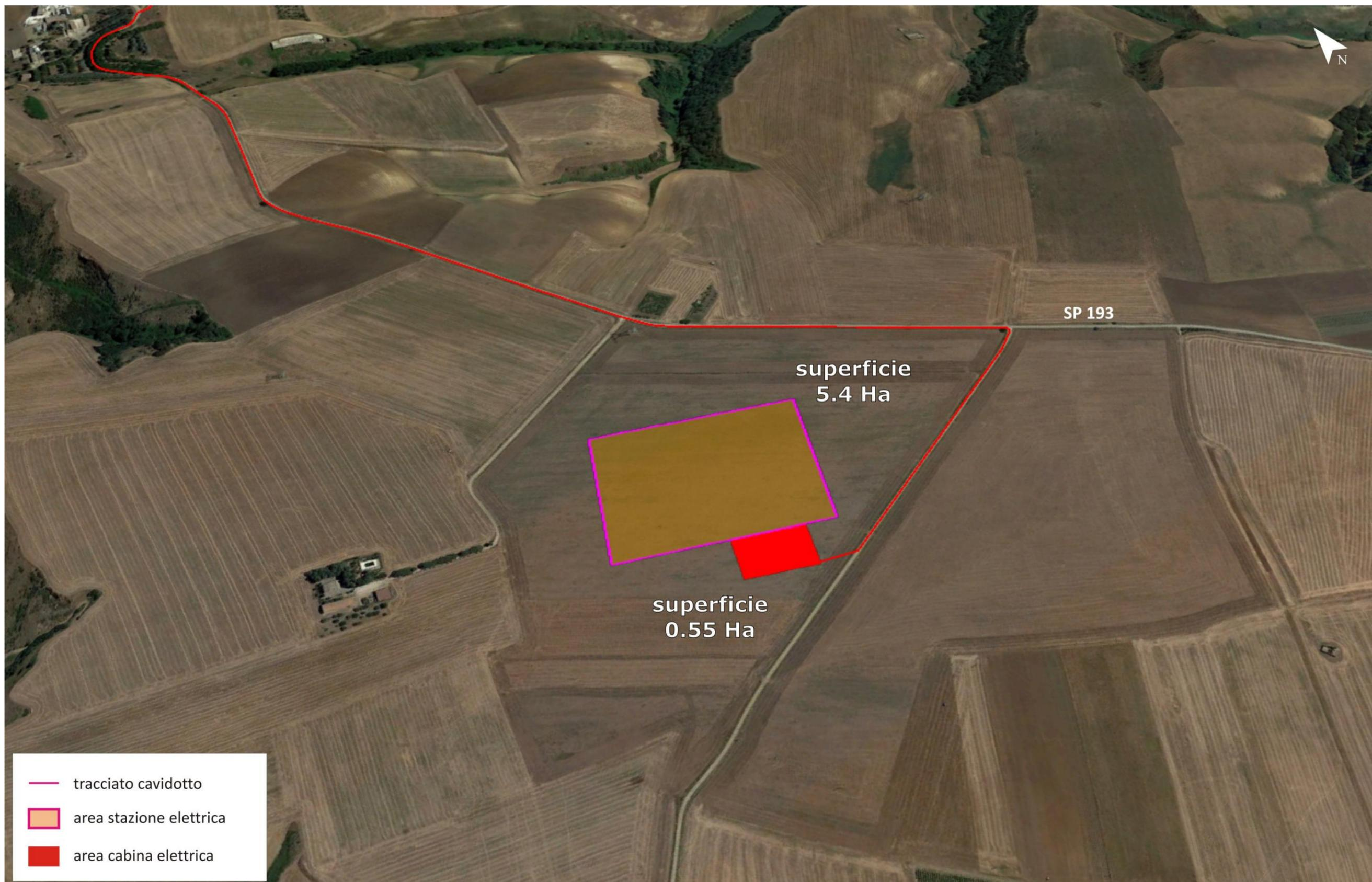
Figura 3 - SETTORE B, area di installazione della cabina elettrica di consegna: layout dell'intervento sovrapposto al modello tridimensionale del terreno estratto da Google Earth.
