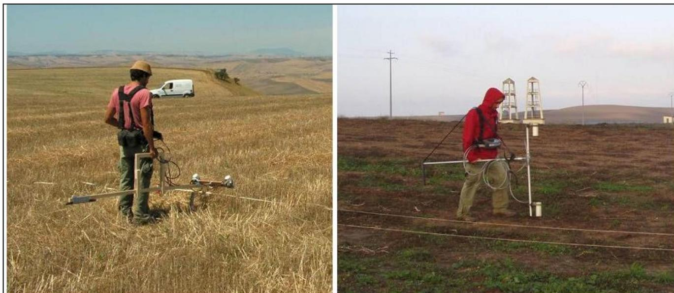
**Figura 6** - Acquisizione dati magnetometrici: configurazione strumentale per misure di intensità di campo magnetico (sensori disposti in parallelo) e di gradiente (sensori disposti in verticale).
