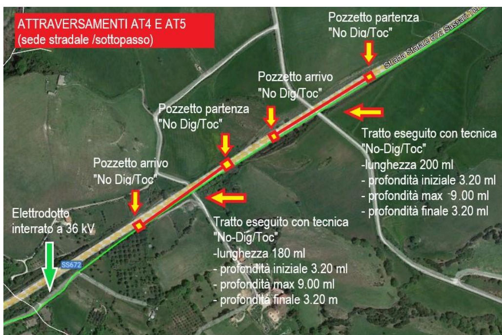
Rappresentazione su ortofoto degli attraversamenti 4 (AT4) e 5 (AT5) con tecnica "No-Dig/Toc"
