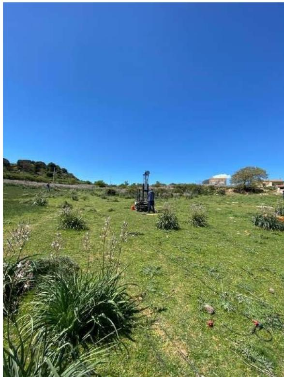
***Prova penetrometrica dinamica continua DPSH -1***
