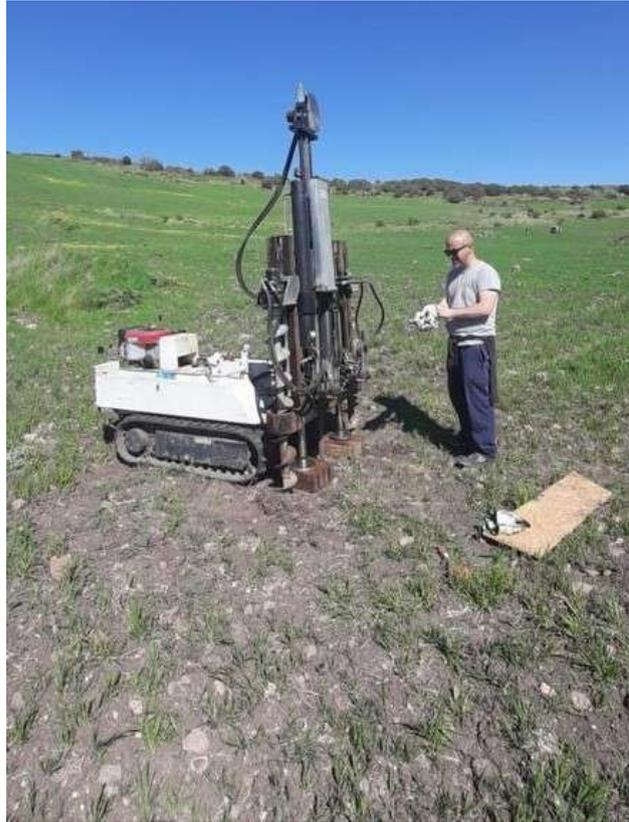
***Prova penetrometrica dinamica continua DPSH -8***
