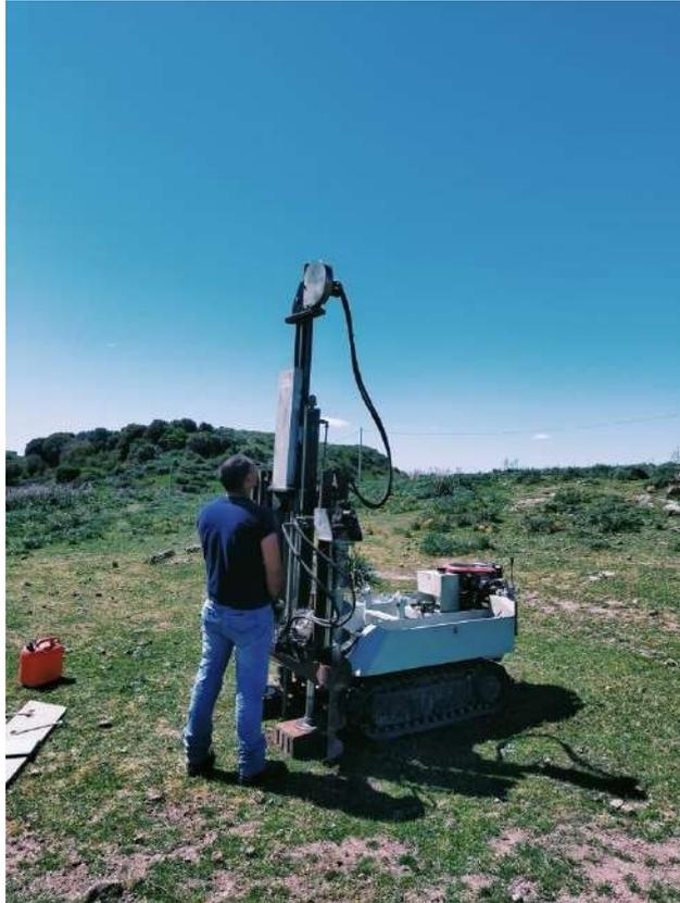
***Prova penetrometrica dinamica continua DPSH -2***
