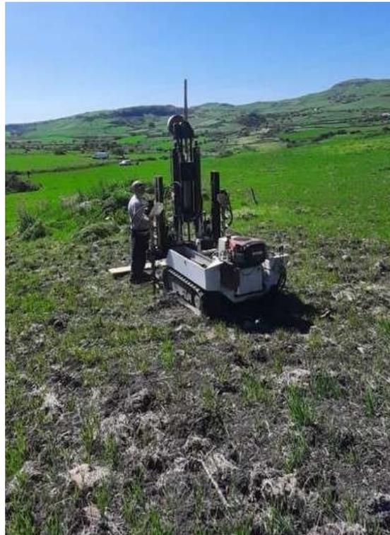
***Prova penetrometrica dinamica continua DPSH -1***
