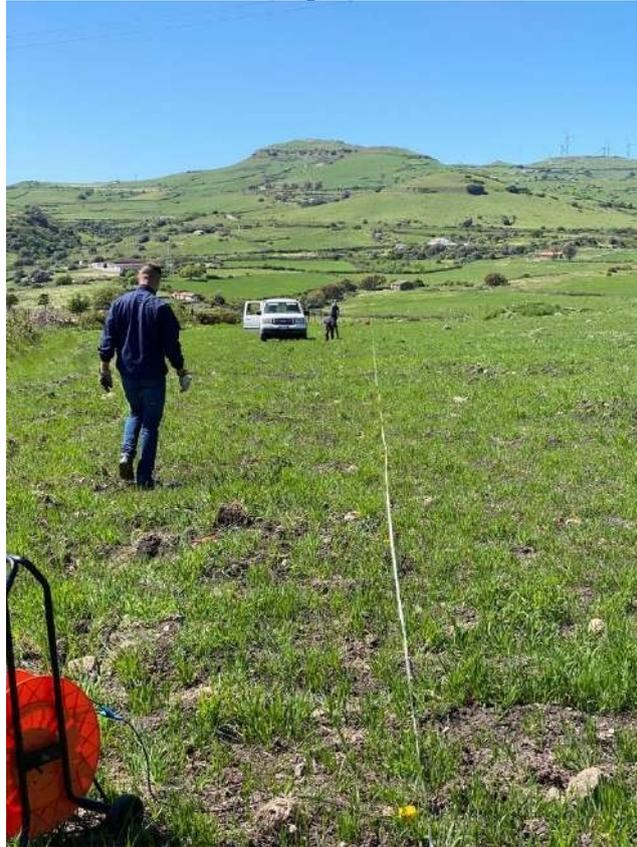
***Sismica a rifrazione P6***
