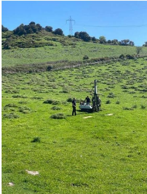
***Prova penetrometrica dinamica continua DPSH -1***
