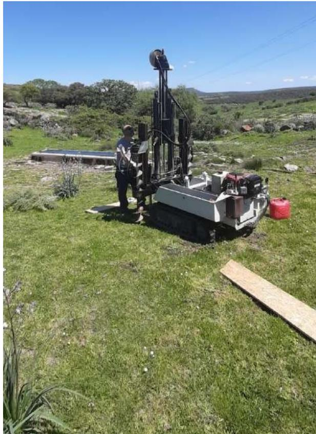
***Prova penetrometrica dinamica continua DPSH -4***
