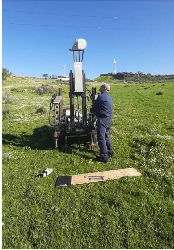
***Prova penetrometrica dinamica continua DPSH -6***
