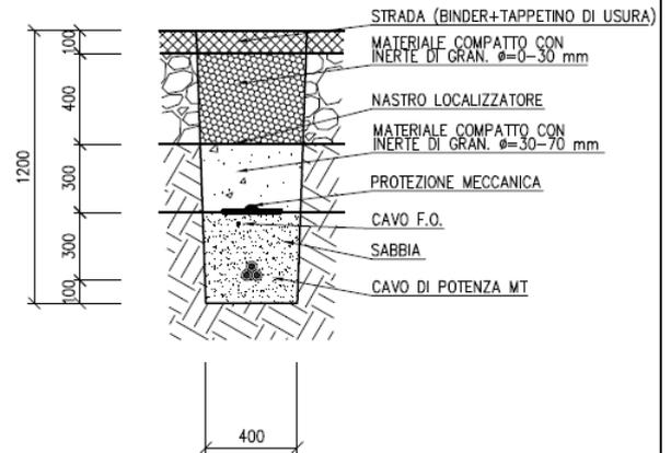
Le terminazioni dei cavi di MT saranno dotate di terminali unipolari, con isolamento estruso, mentre gli schermi dei cavi stessi saranno messi a terra in corrispondenza delle terminazioni. I giunti che si andranno ad impiegare saranno quelli unipolari dritti, con isolamento a spessore ridotto e schermo in tubo di alluminio. Infine i cavi saranno ulteriormente protetti tramite la posa, superiormente ad essi, di tegoli di protezione.
