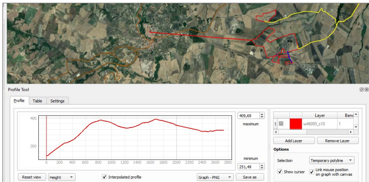
Figura 6-5: profilo DTM tra l'abitato di Rotello e i campi FV
