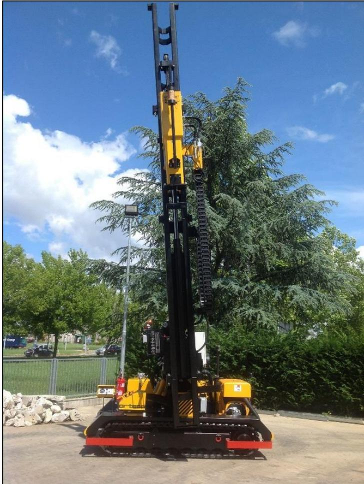
Tramite utilizzo di macchine battipalo saranno infissi i pali di sostegno per i tracker elevati da terra. Si evidenzia che le strutture saranno infisse senza l'utilizzo di fondazioni in cemento.
