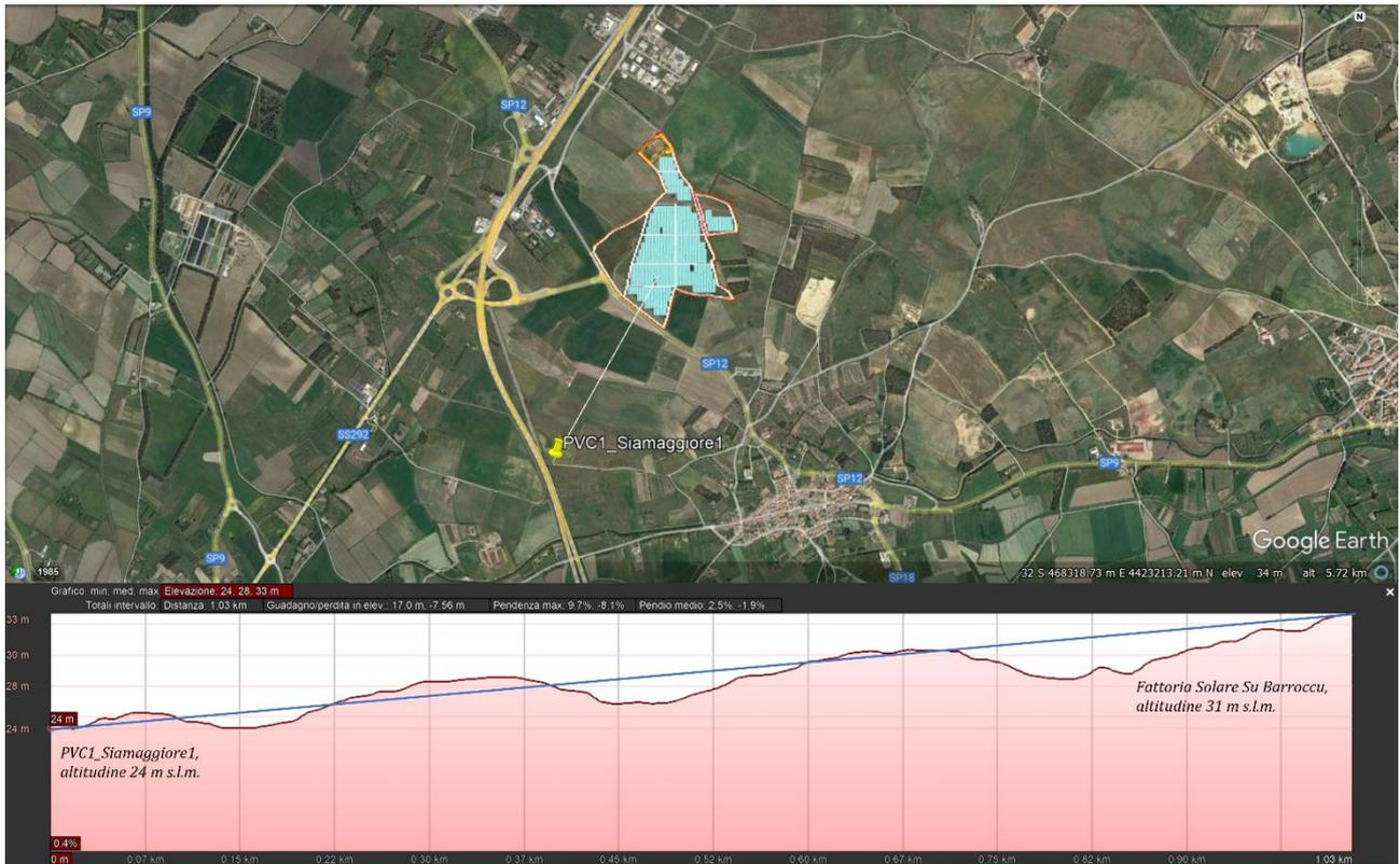
*Figura 34: Profilo altimetrico della direttrice di collegamento tra il PVC1 e l'area d'impianto*
