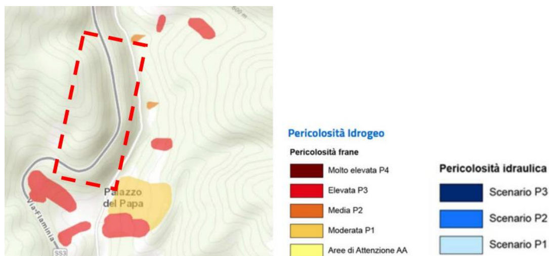
Figura 13: Localizzazione degli interventi in relazione con le aree a rischio alluvioni e frane (Fonte: Lista di controllo)
