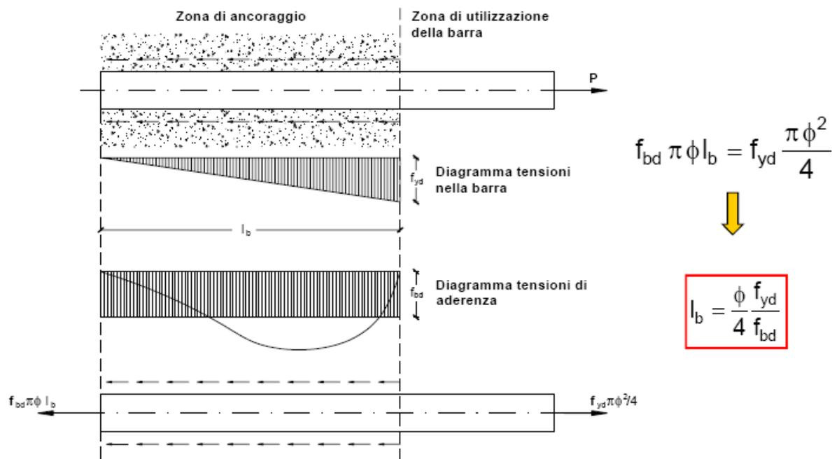
dove  $f_{bd}=f_{bk}/\gamma_c$  è la tensione tangenziale di aderenza acciaio-calcestruzzo e  $f_{bk}=2.25\eta f_{ctk}$  è la resistenza tangenziale caratteristica di aderenza ( $\eta=1$  per  $\phi \leq 32$  mm).
