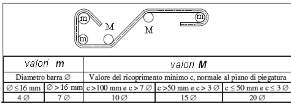
Di seguito si riportano i diametri dei mandrini da adoperare per la piegatura delle barre di armatura previste in progetto. Si farà riferimento al mandrino piccolo "m" per le piegature a realizzare gomiti e uncini e mandrino grande "M" per le piegature a realizzare deviazioni e ancoraggi.
