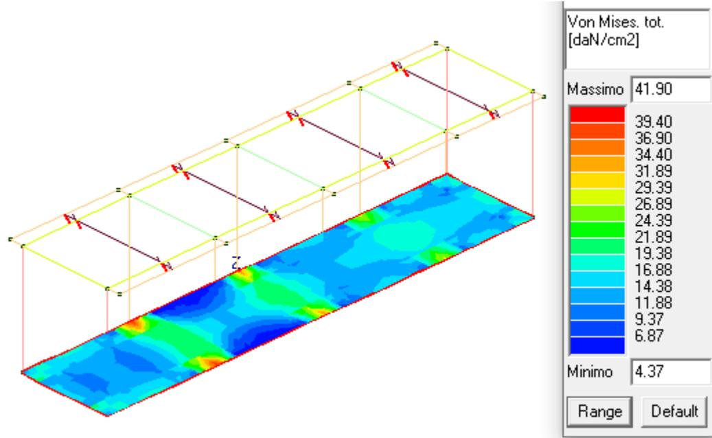
Mapa cromatica delle tensioni totali (membrana + flessione) ottenute mediante la formulazione di Von Mises
