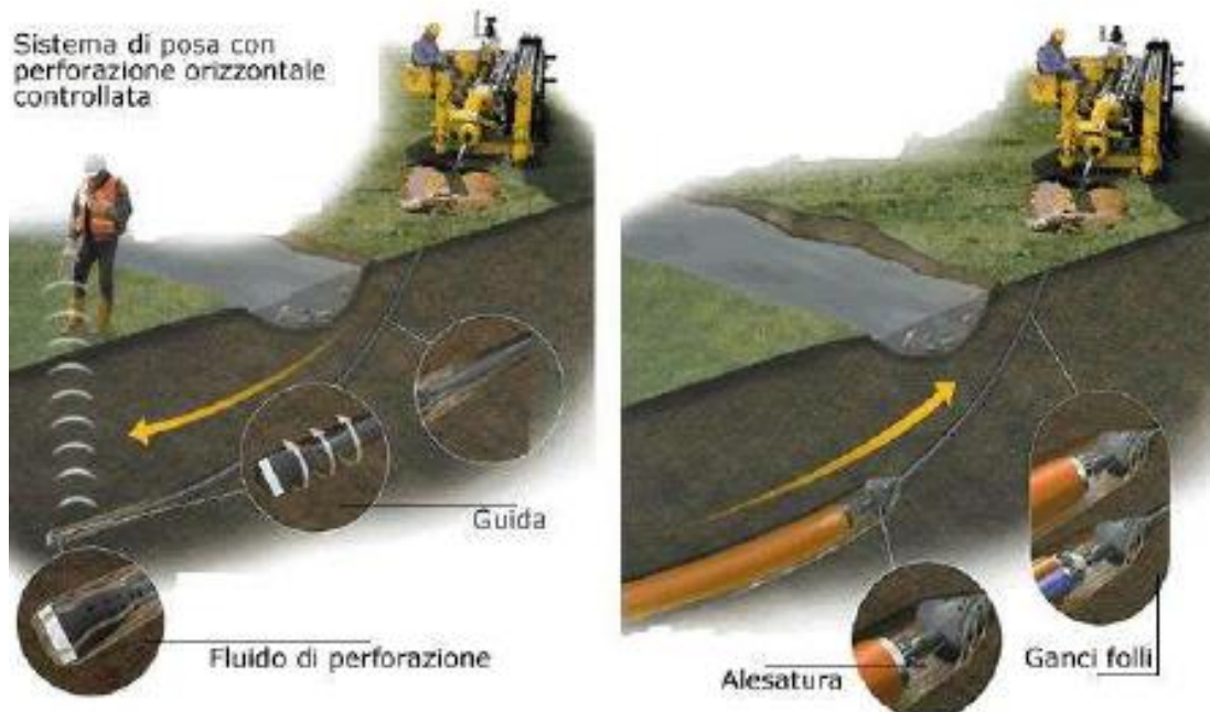
Posa in opera tubazione con trivellazione teleguidata
