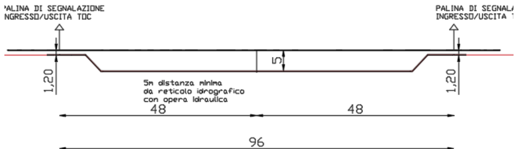
Sezione - Superamento interferenza in T.O.C.
