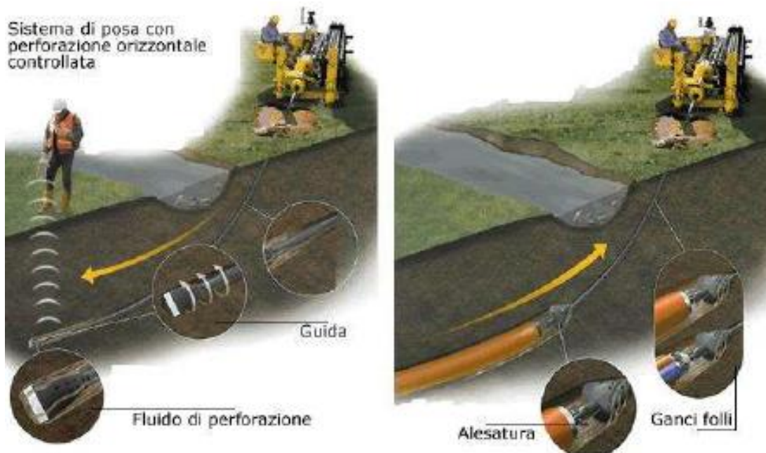
Posa in opera tubazione con trivellazione teleguidata
