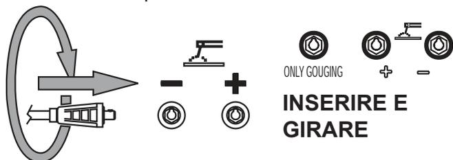
Assicurarsi che la pinza di massa, il cui cavo va collegato alla presa - o a quella +, secondo il tipo d'elettrodo, faccia un buon contatto e che sia, possibilmente, vicina alla posizione di saldatura.
