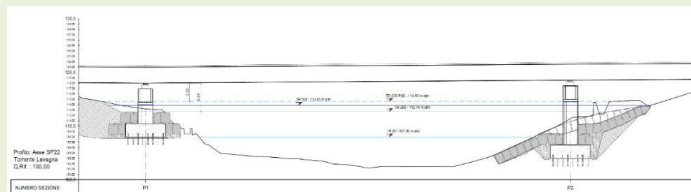
Figura 3 – Dettaglio sezione trasversale campata centrale viadotto Lavagna
