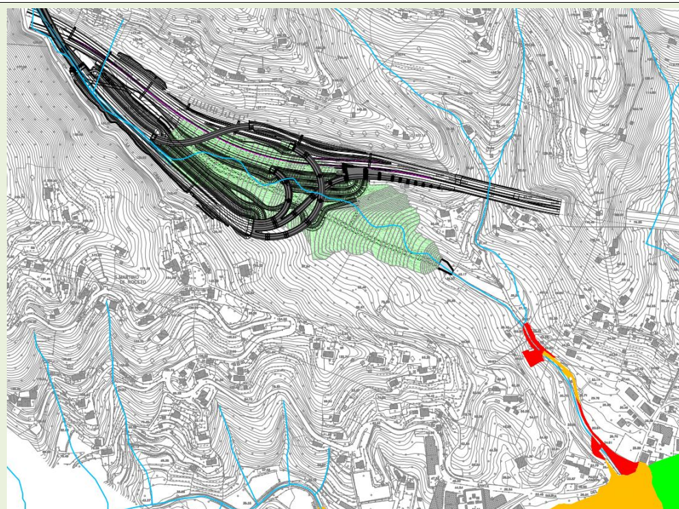
Figura 1 – Individuazione fasce inondabilità lungo rio Tangon
