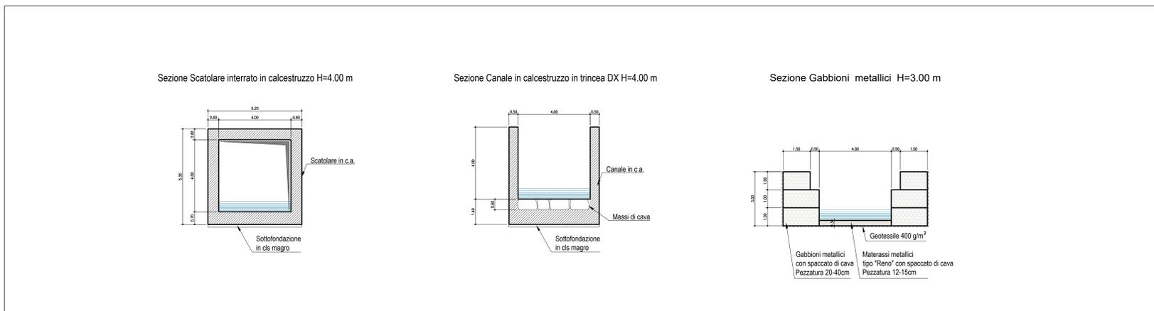
Sezioni tipologiche di dettaglio della sistemazione idraulica con gabbioni - Scala 1:100
