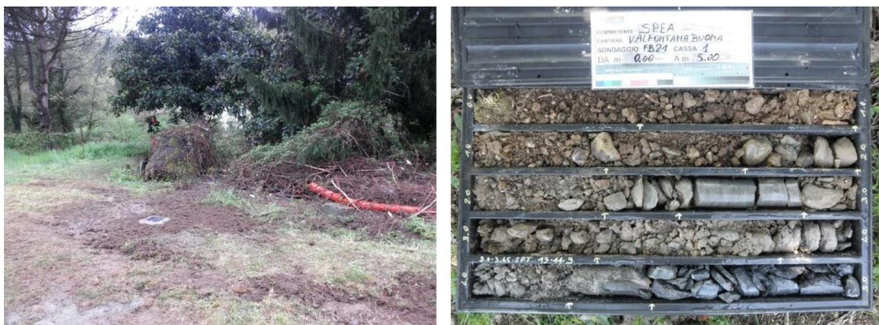
Figura 2-4. A sx posizionamento del sondaggio FB21, a dx cassetta contenete le carote comprese tra 0 e -5m dal p.d.c.
