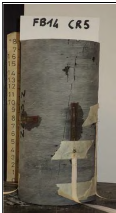
Descrizione rottura: lungo piano subverticale.
