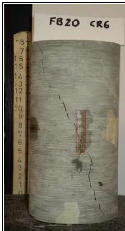
Descrizione rottura: lungo piano inclinato di circa 80°.
