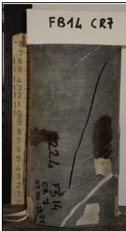
Descrizione rottura: lungo piano subverticale.
