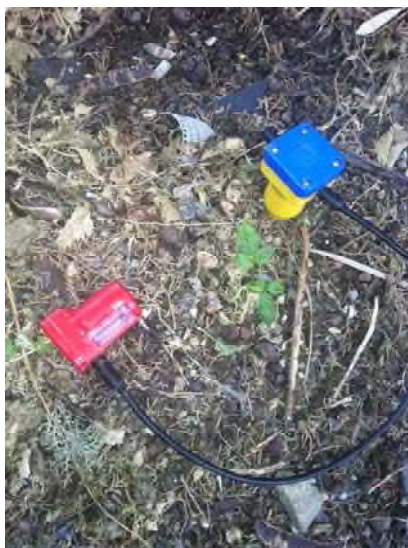
Immagine di dettaglio relativa ai geofoni orizzontali (rossi) e verticali (gialli)
