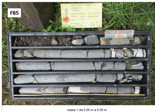
Figura 3-10 – Spessore e natura della copertura, sondaggi FB5 e FB6.
