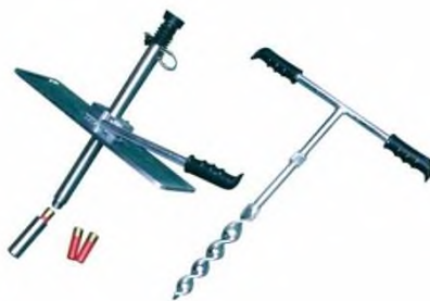
Figura 2 Energizzatore a cartuccia per onde di taglio e compressionali
