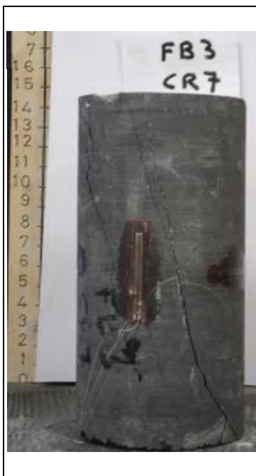
Descrizione rottura: lungo anisotropie planari inclinate di circa 75°.
