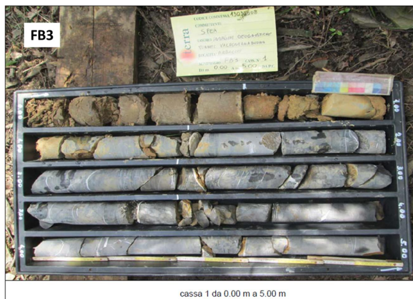
Figura 3-12 – Sondaggio FB3 (0-5m)
