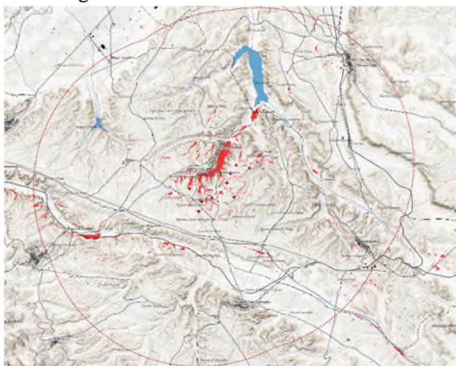
**Fig.5** Incremento della visibilità teorica dovuta agli aerogeneratori di progetto
