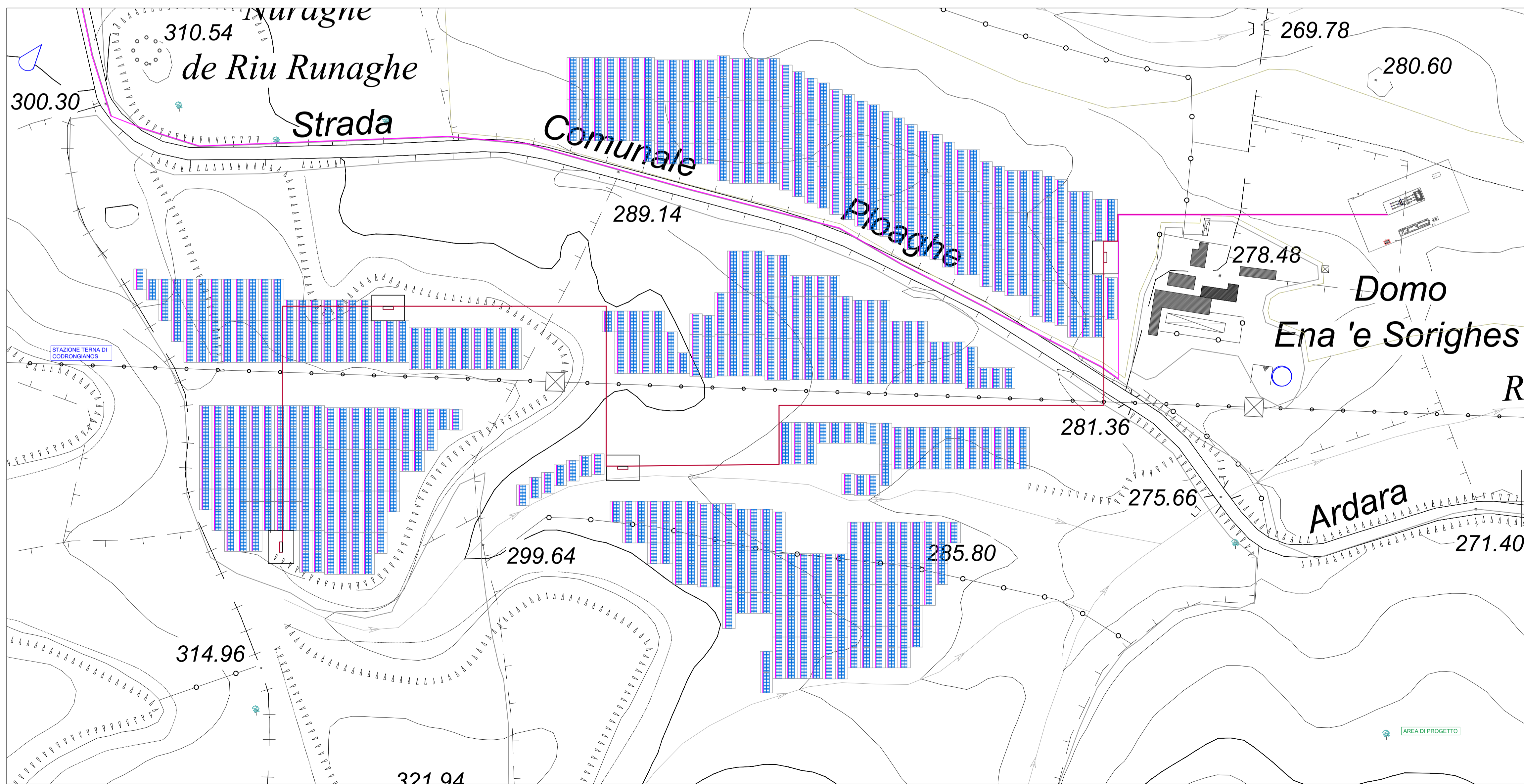
DISTRIBUZIONE CAVIDOTTI INTERNI AL PROGETTO 1:2000
