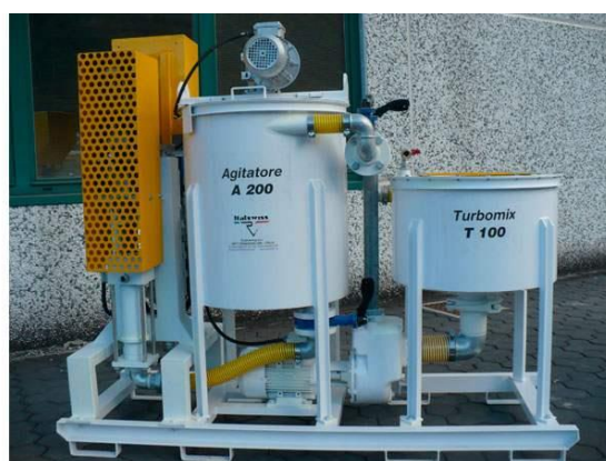
Impianto miscelazione boiacche
