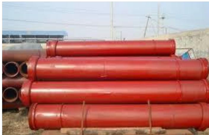
Stoccaggio a terra dei tubi getto
