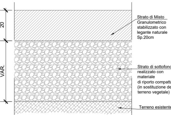
BASAMENTO AREA DI CANTIERE (Sez. Tipo B) Scala 1:10
