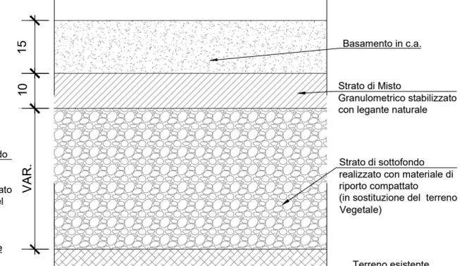
PAVIMENTAZIONE DRENANTE IMPERMEABILE (Sez. Tipo C) Scala 1:10
