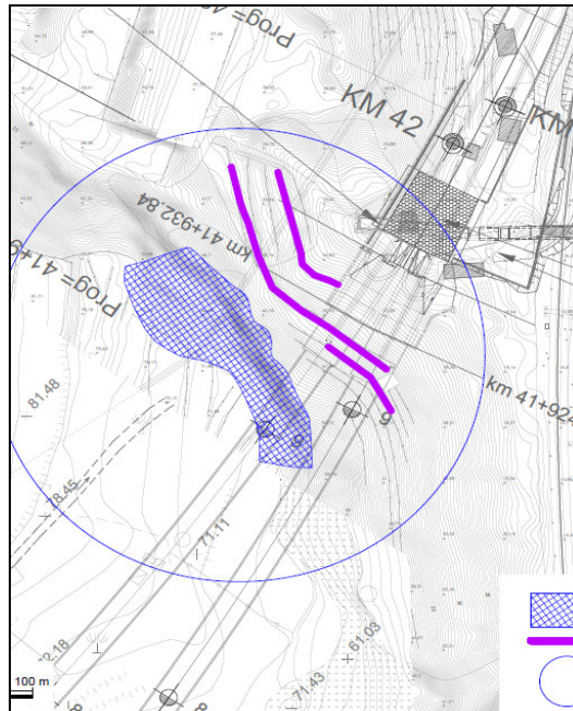
PE: Interventi di protezione versante instabile Imbocco G. Scaletta lato Messina
