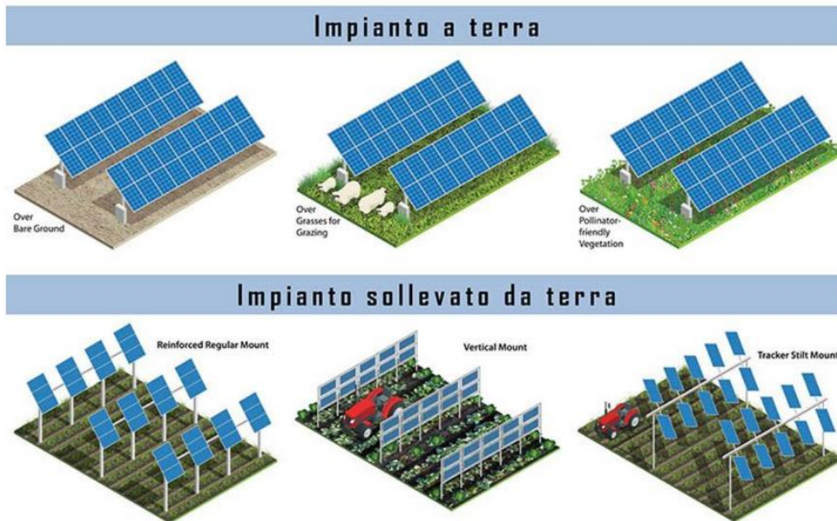
Figura 16 - Tipologie di impianti agrivoltaici, fonte NREL
