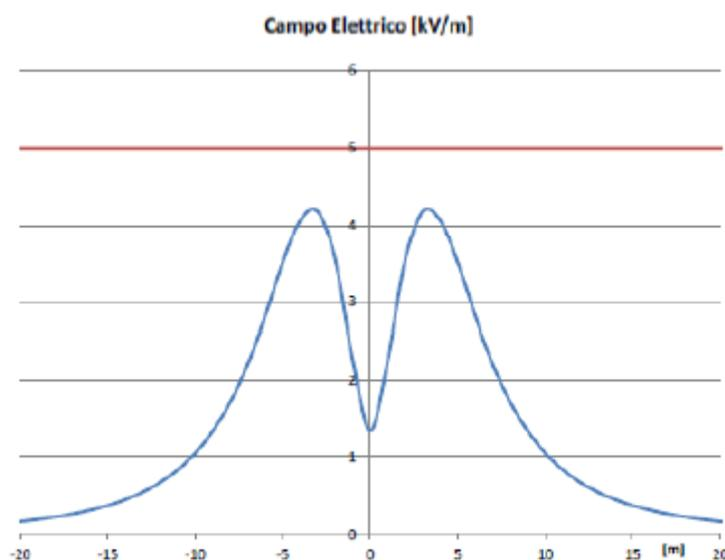
*Figura 58 – Campo elettrico al suolo generato dal sistema di sbarre a 150 kV*
