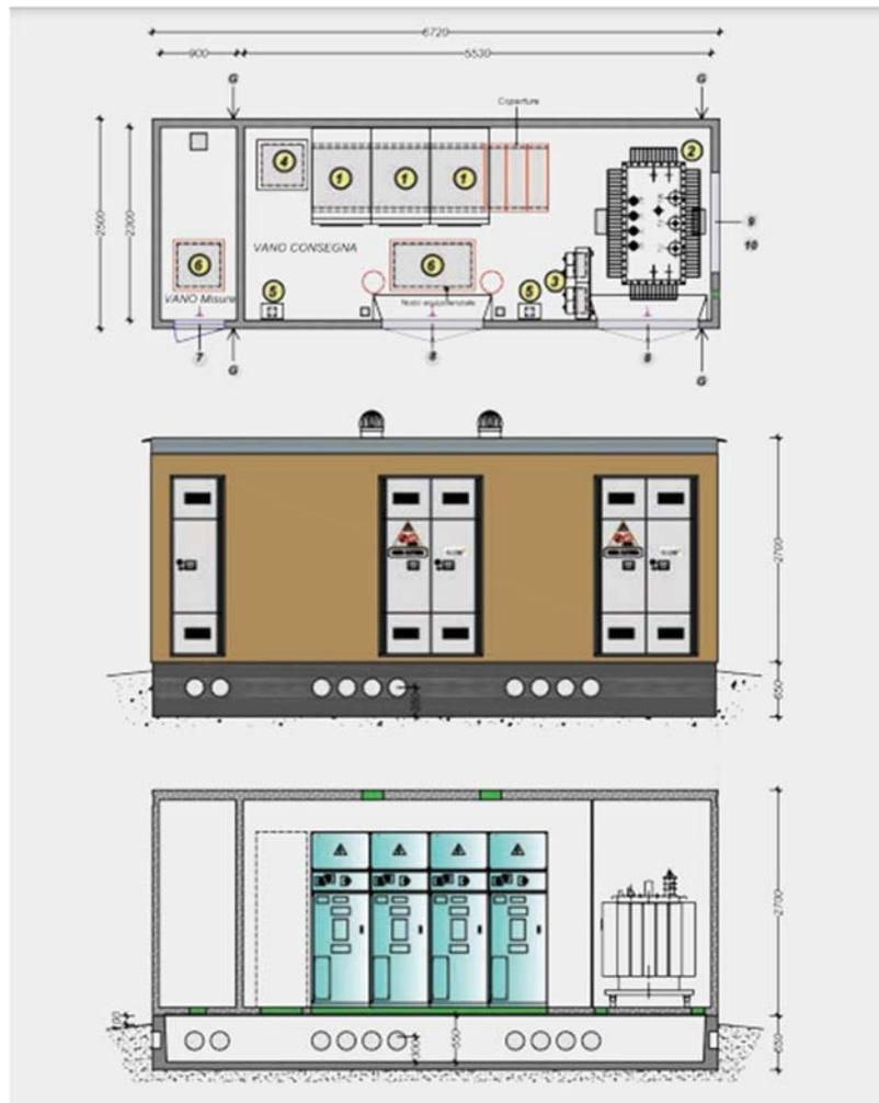
Figura 7- Esempio di cabina omologata
