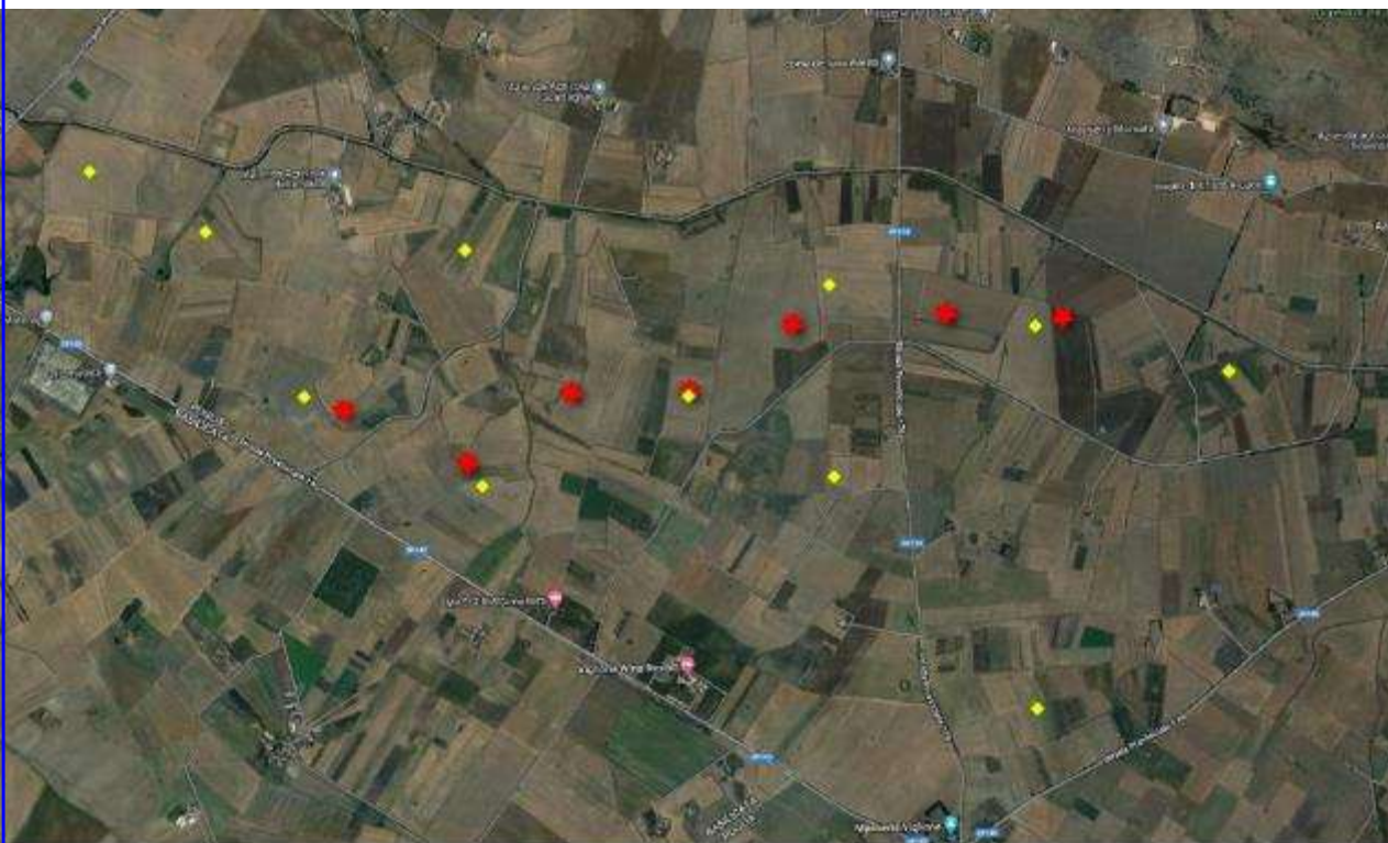
Stralcio su ortofoto dei punti macchina proposti da IBERDROLA (in giallo) e dei punti macchina del progetto ENIT (in rosso)
