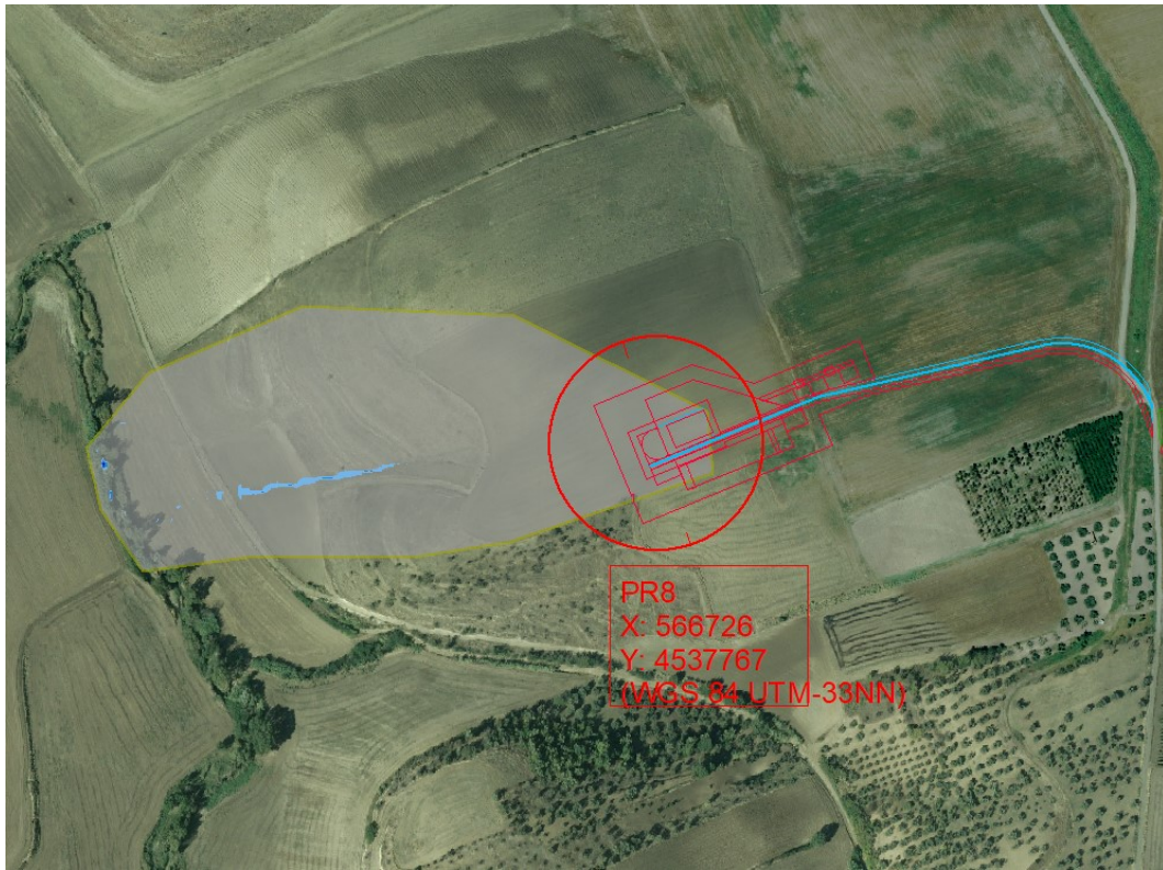
Figura 40: Dettaglio del settimo dominio di calcolo con indicazione delle aree allagabili a 200 anni. Non sono state inserite sezioni di controllo in quanto non sono state evidenziate interazioni tra opere di progetto e aree allagabili.
