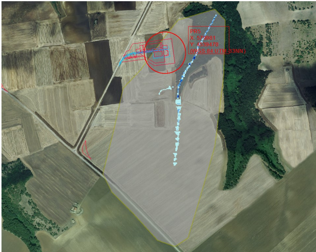
Figura 34: Dettaglio del quarto dominio di calcolo con indicazione delle aree allagabili a 200 anni. Non sono state inserite sezioni di controllo in quanto non sono state evidenziate interazioni tra opere di progetto e aree allagabili.
