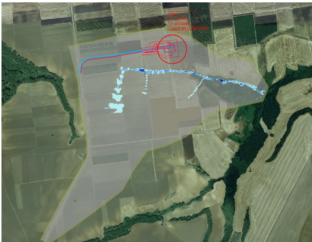
Figura 38: Dettaglio del sesto dominio di calcolo con indicazione delle aree allagabili a 200 anni. Non sono state inserite sezioni di controllo in quanto non risultano interferenze.
