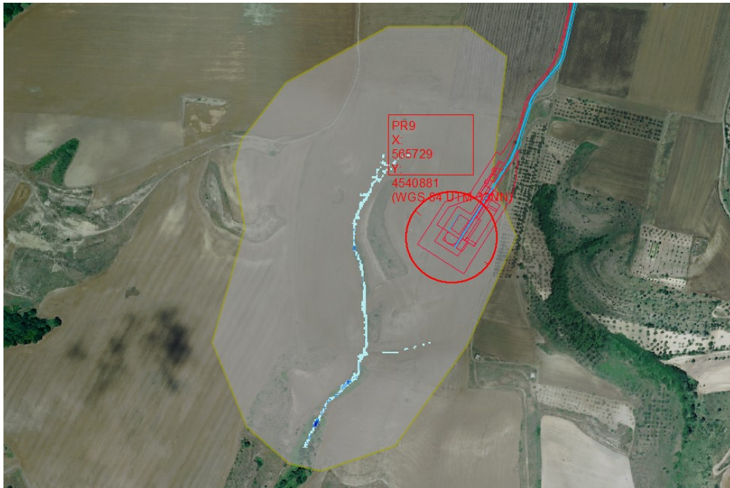
Figura 50: Dettaglio del dodicesimo dominio di calcolo con indicazione delle aree allagabili a 200 anni. Non sono state inserite sezioni di controllo in quanto non risultano interferenze.
