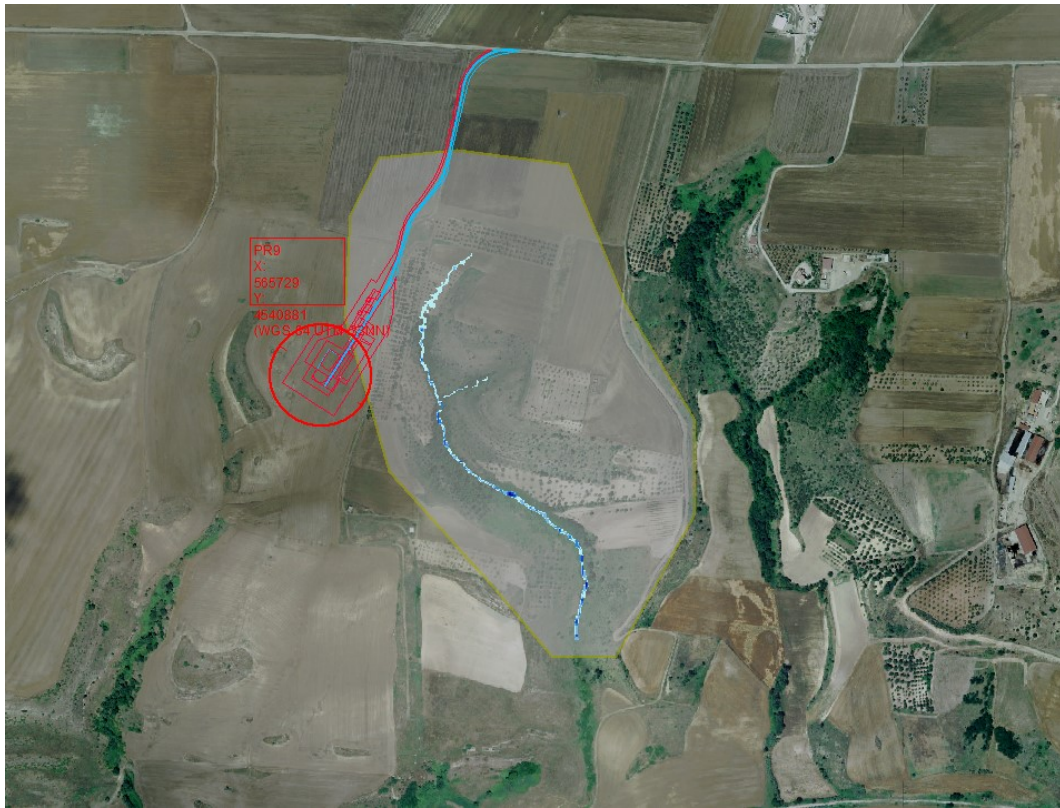
Figura 42: Dettaglio dell'ottavo dominio di calcolo con indicazione delle aree allagabili a 200 anni. Non sono state inserite sezioni di controllo in quanto non sono state evidenziate interazioni tra opere di progetto e aree allagabili.
