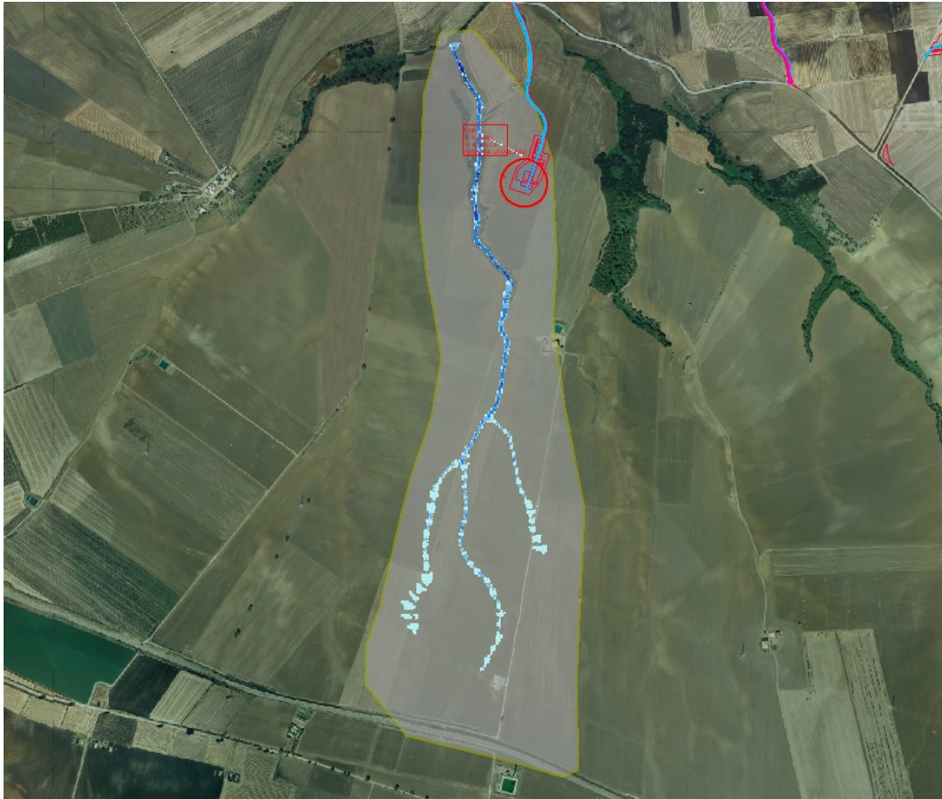
Figura 36: Dettaglio del quinto dominio di calcolo con indicazione delle aree allagabili a 200 anni. Non sono state inserite sezioni di controllo in quanto non risultano interferenze.
