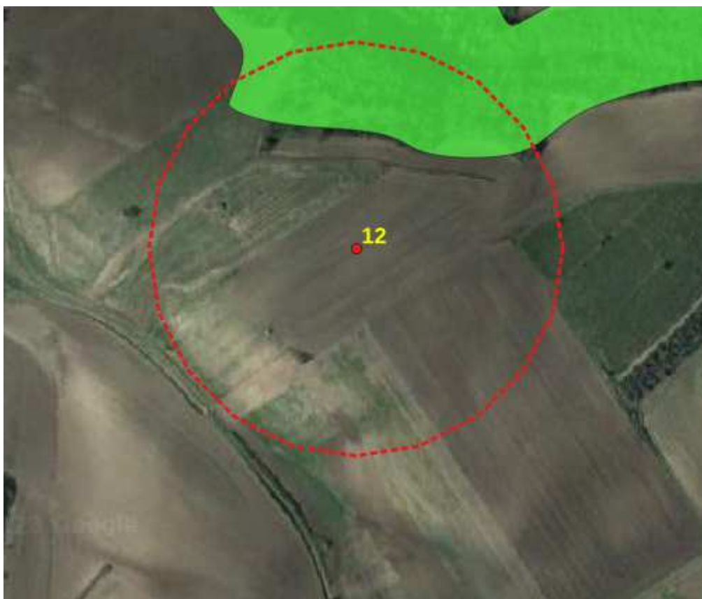
Buffer 200 m (tratteggio rosso) bosco (in verde) e wtg in progetto (pallino rosso)
