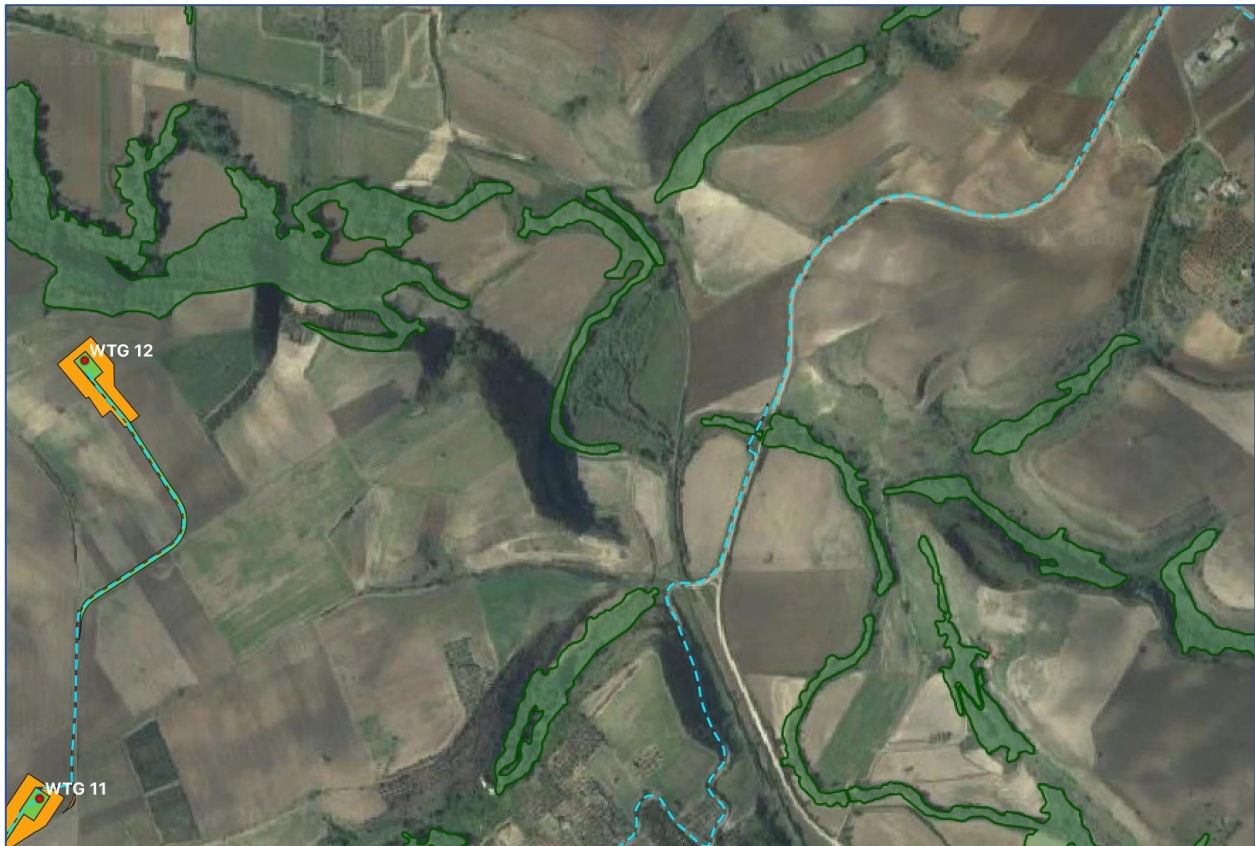
Figura 10- Interferenza del cavidotto con le "Formazioni igrofile"
