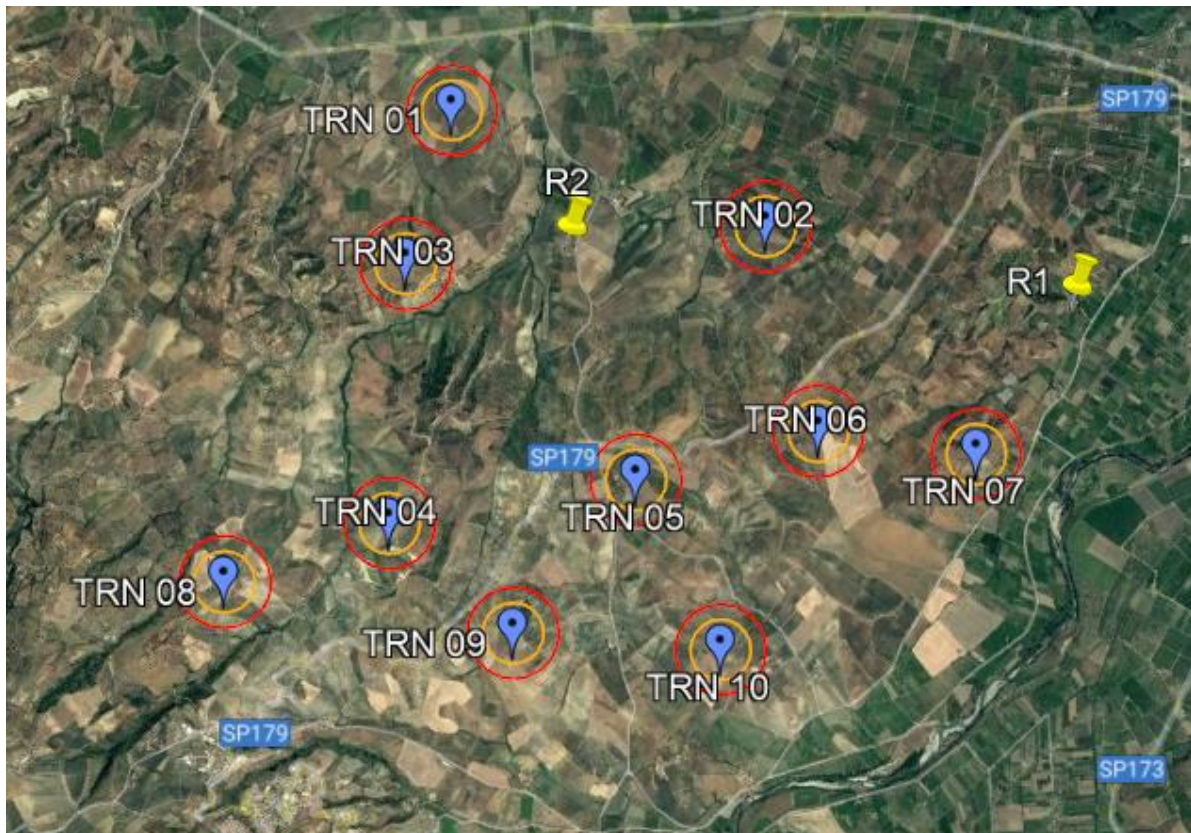
Figura 17-30 Buffer di raggio pari a 200 m (in arancione) e pari a 300 m (in rosso) e recettori residenziali (R1 e R2)
