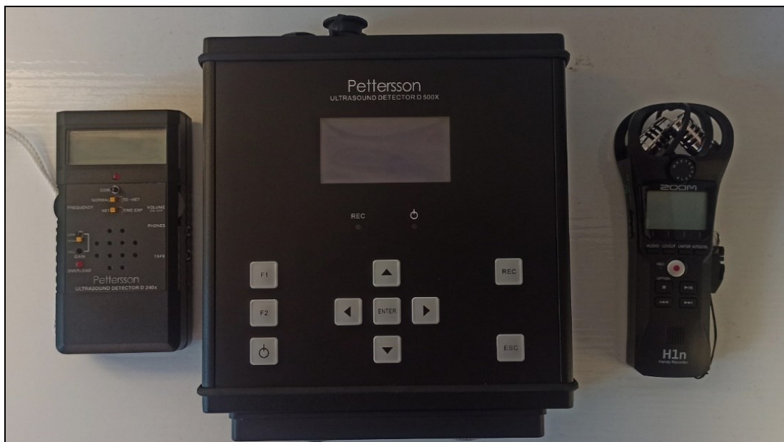
Figura-1: Attrezzatura utilizzata per il monitoraggio dei chiroteri. Da destra verso sinistra: Rilevatore a eterodina ed espansione temporale (x10 e x20 selezionabile). Bat detector D 500X per la registrazione prolungata in campo degli ultrasuoni . Registratore multitraccia collegato al D 240X.
