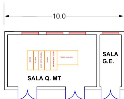
EDIFICIO SERVIZI - DISPOSIZIONE DELLE APPARECCHIATURE INTERNE
