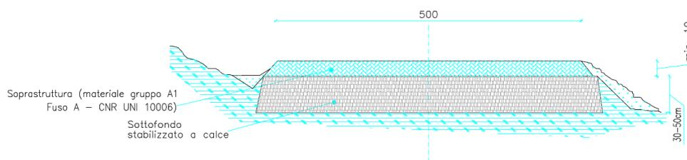
**Figura 1- Sezione tipo stradale**
