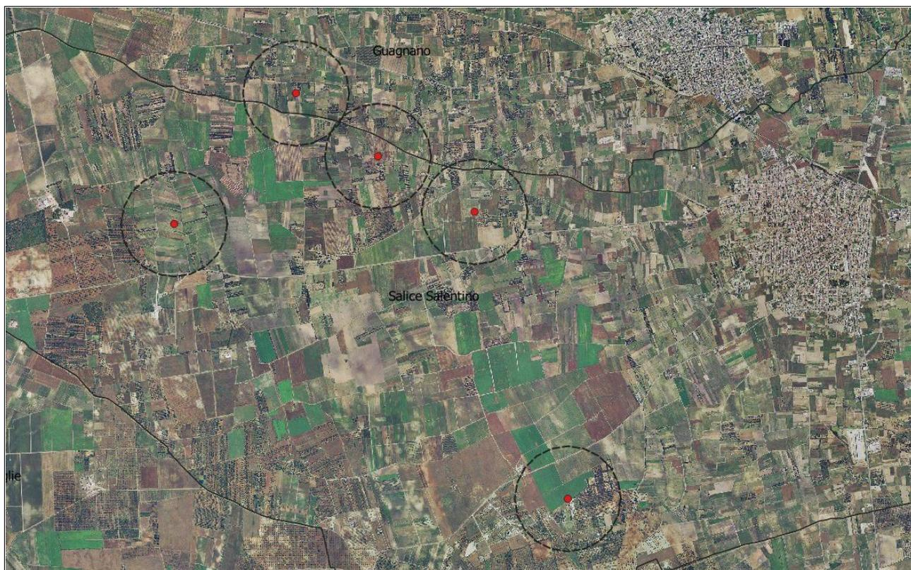
**Figura 19** - In evidenza su ortofoto, il posizionamento previsto per i 5 aerogeneratori in progetto; la linea tratteggiata indica il limite del buffer di 500 m dai punti previsti.
