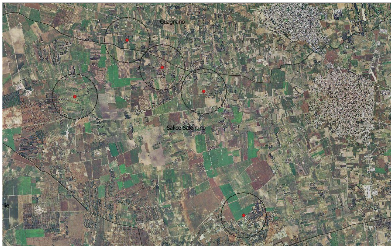
Figura 12 - In evidenza su ortofoto, il posizionamento previsto per i 5 aerogeneratori in progetto. La linea tratteggiata evidenzia il limite del buffer di 500 m, area in cui è stata verificata la presenza di appezzamenti a colture di pregio.
