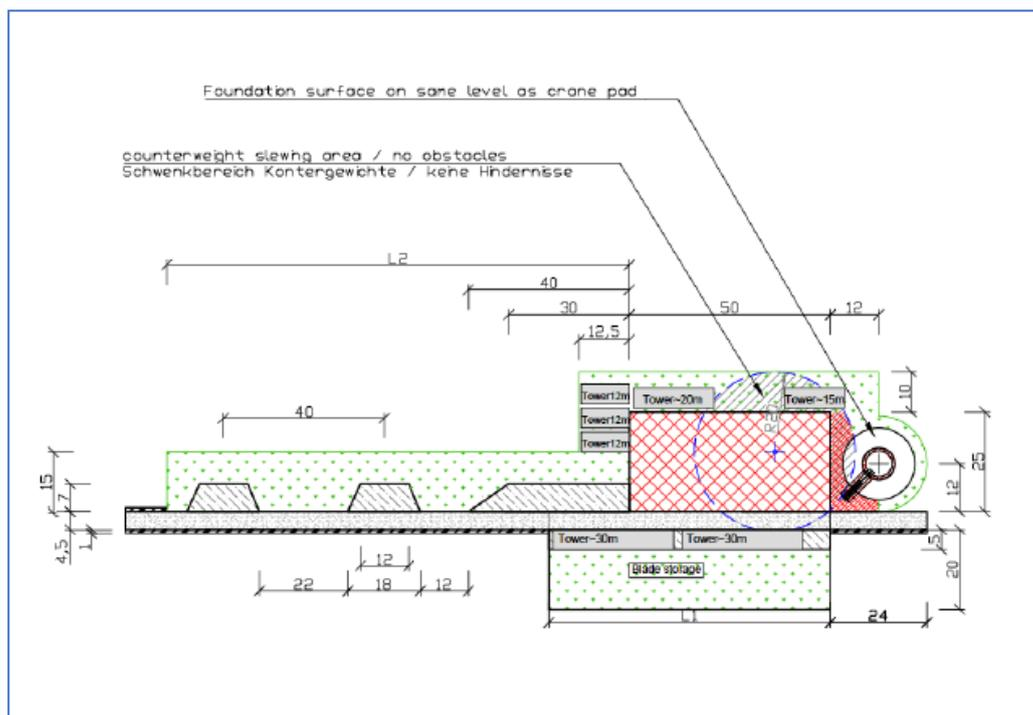
Figura 15 – tipologico della piazzola di montaggio
