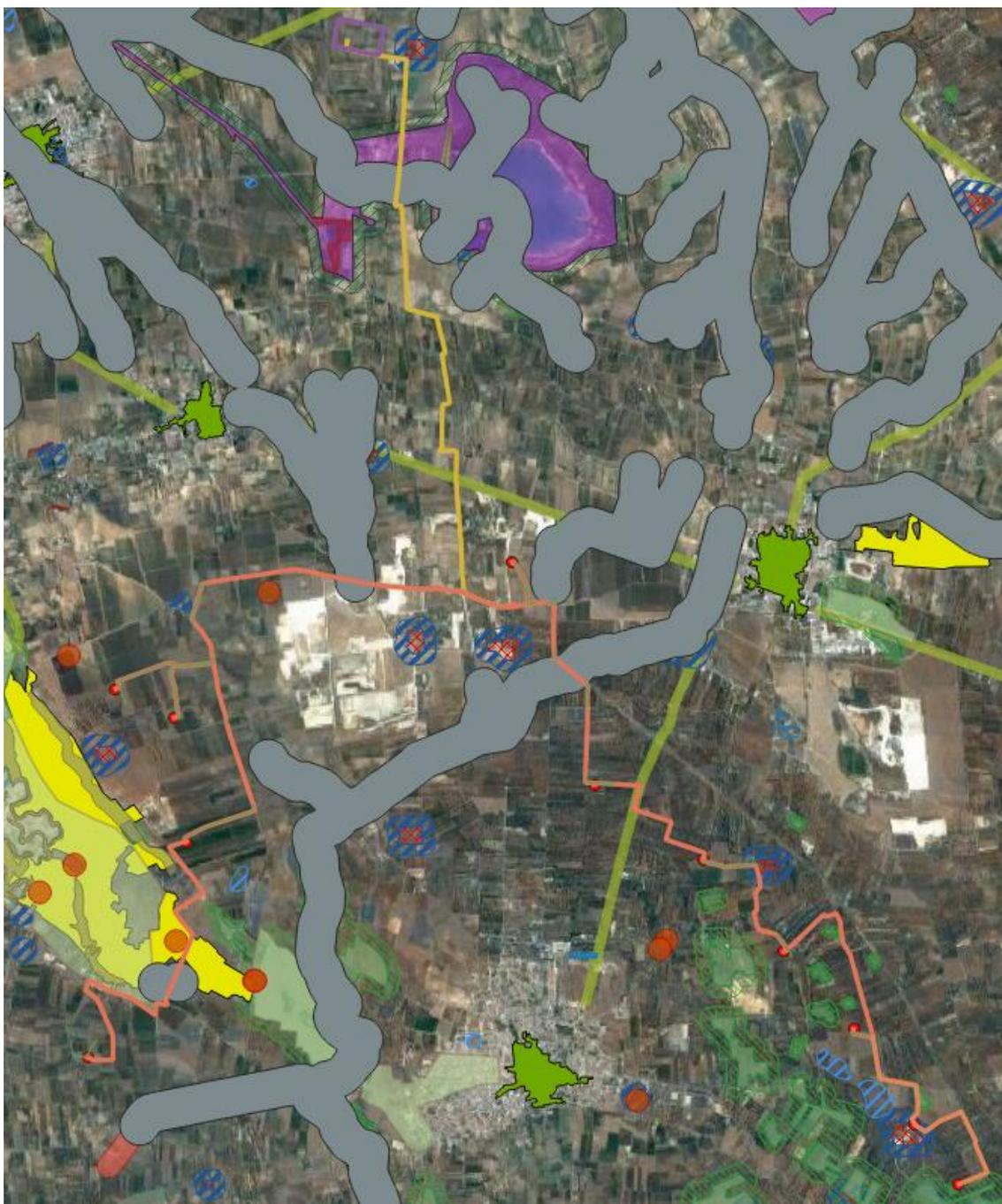
*Figura 4 - Ipotesi di layout a 11 aerogeneratori - analisi vincolistica e buffer dai canali*
